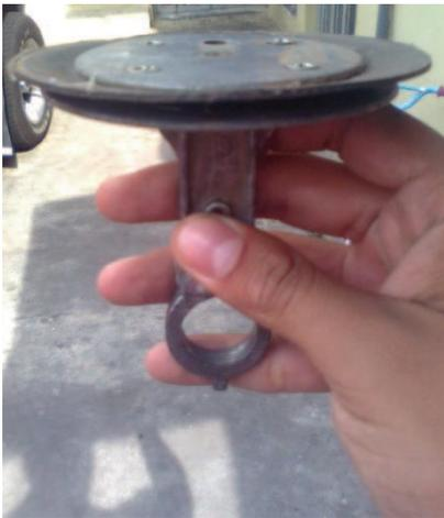
**Figura 3.17 Membrana y brazo de biela**
