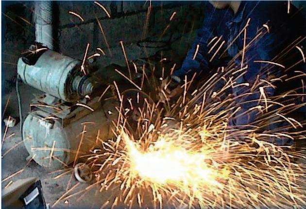
**Figura 3.4** Corte del tanque del compresor
