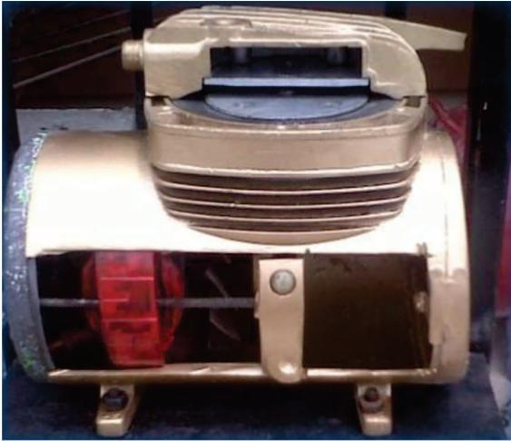
**Figura 3.7** Corte del compresor de membrana
