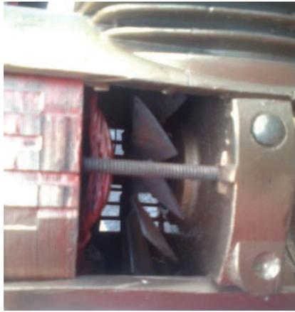
**Figura 3.19** Membrana y brazo de biela
