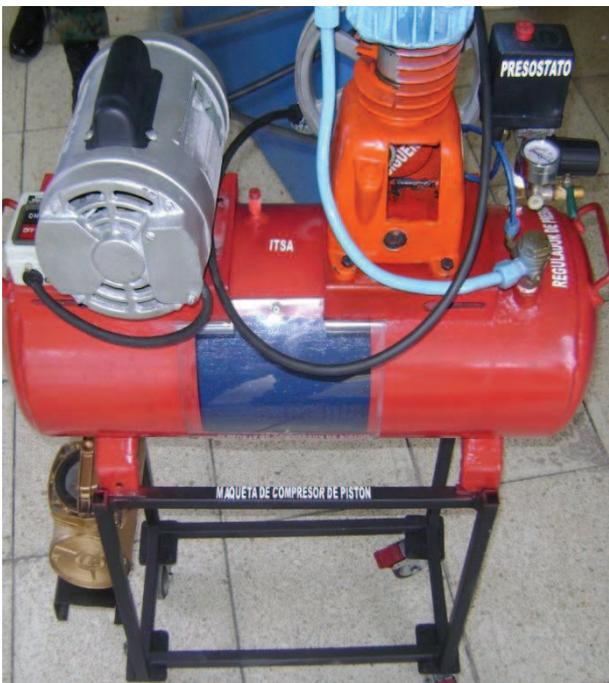
**Figura 3.23** Maqueta de los compresores seccionados 2
