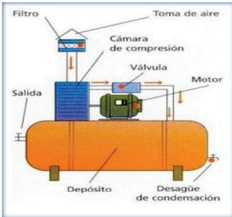
**Figura 2.18** Compresor alternativo (de pistones)
