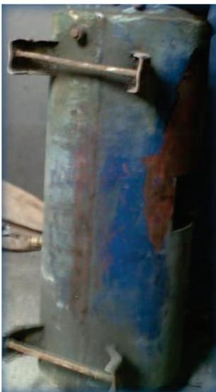
**Figura 3.3** Estado del compresor de pistón
