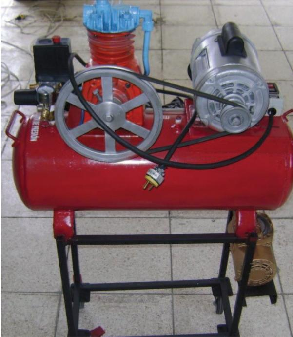
**Figura 3.22** Maqueta de los compresores seccionados 1
