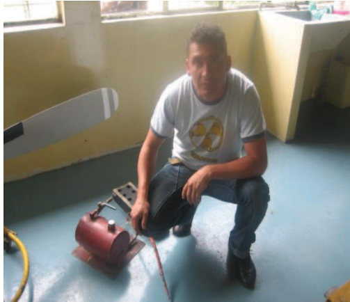
Figura 4. Banco de pruebas de lavado y limpieza de inyector inoperable
