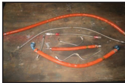
Fig. 2.16 Cañerías de presión
