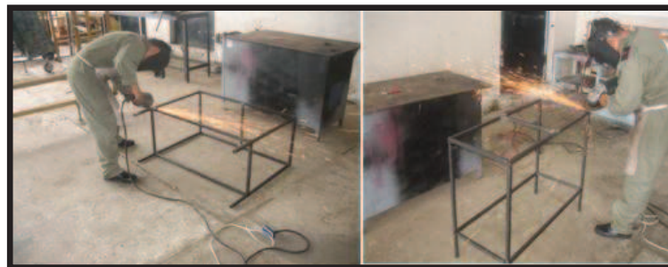
Figura 3.8 Pulido de los puntos de suelda
