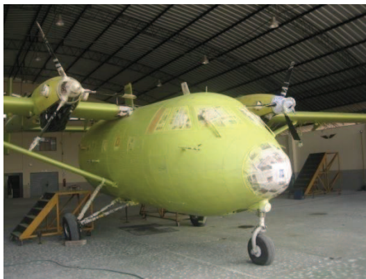
Figura 8. Avión Araba en inspección de 2400 horas
