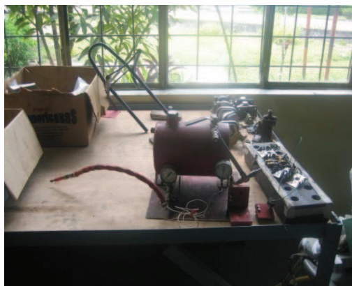
Figura 3. Banco de pruebas de lavado y limpieza de inyector inoperable
