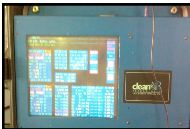
FIGURA 4.2. Medidor de gases a bordo cleanAIR.
