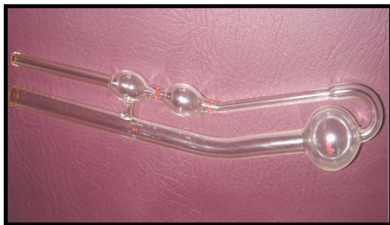
FIGURA 1.23 Viscosímetro Canon-Fenske para líquidos transparentes.
