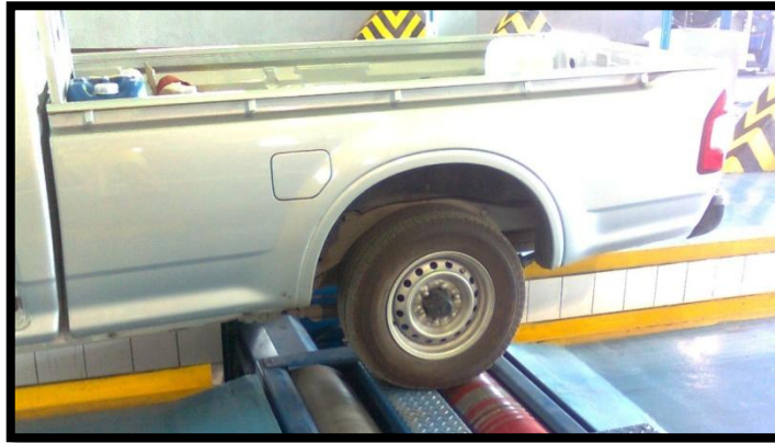
FIGURA 4.5. Vehículo en el dinamómetro de prueba.
