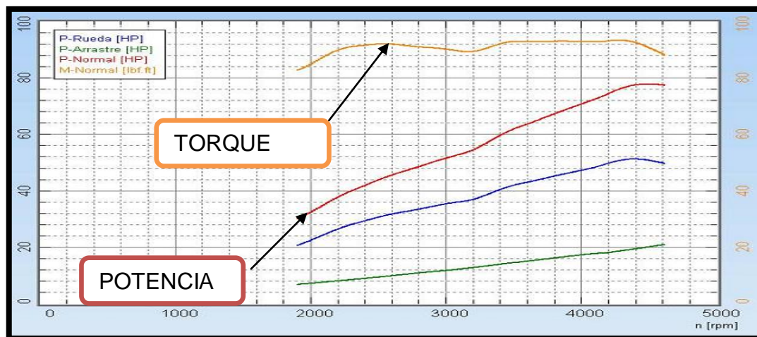
FIGURA 4.13 Curva obtenida en mezcla con aceite al 10%.
