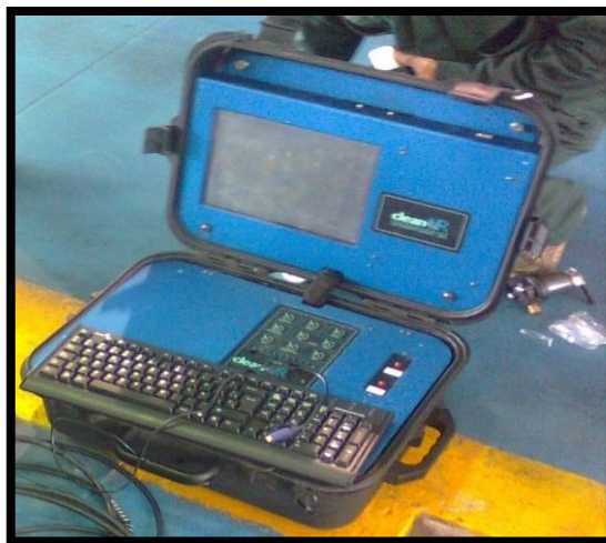
FIGURA 4.3. Opacímetro y medidor de gases utilizado en las pruebas
