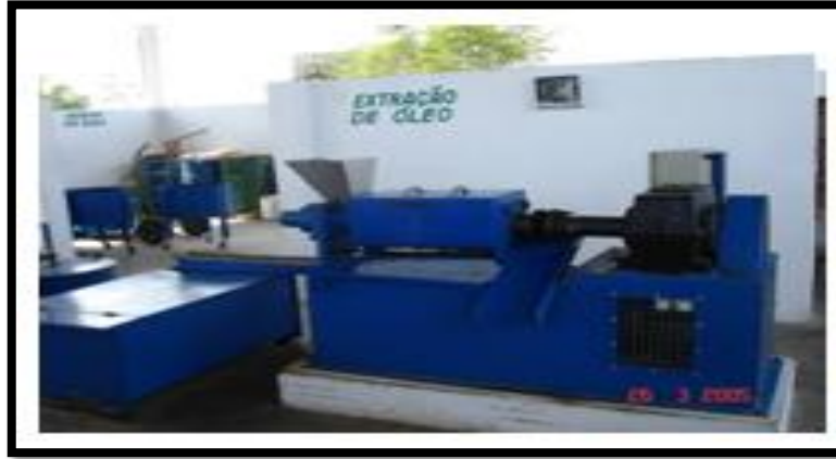
FIGURA 2.8. Prensa para la extracción de aceite de higuera
