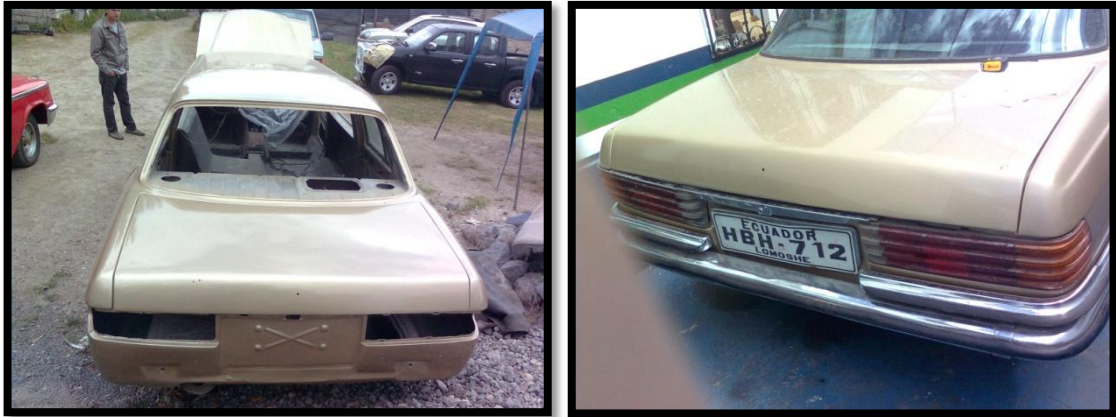
FIG. 3.28 INSTALACIÓN DE FAROS Y GUARDACHOQUE POSTERIOR
