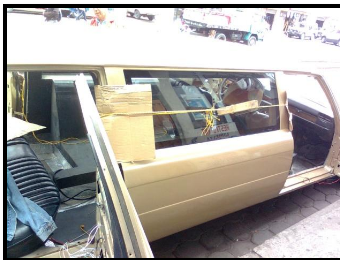
FIG. 3.29 COLOCACIÓN VIDRIOS LATERALES
