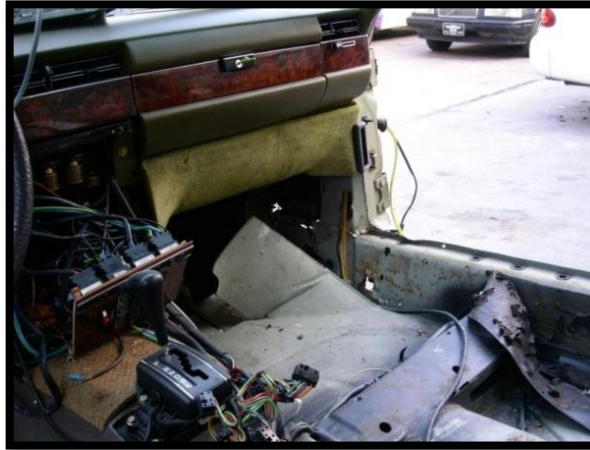
FIG. 2.23 ARNÉS SUELTO EN TODA LA CARROCERÍA
