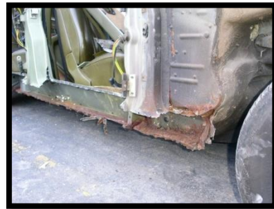
FIG. 4 ÓXIDO EN LATAS DEL VEHÍCULO
