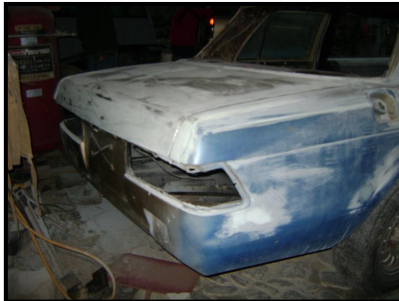
FIG. 3.16 LIJADO EN LATA
