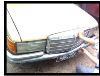
FIG. 23 INSTALACIÓN DE FAROS Y GUARDACHOQUE DELANTERO
