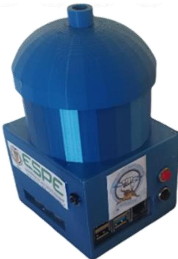
El dispositivo completo permite captar las muestras de aire exhalado por las personas, se muestra los datos recolectados en la interfaz gráfica, permitiendo al personal médico analizar los datos y determinar los niveles de gases químicos en el cuerpo humano.
