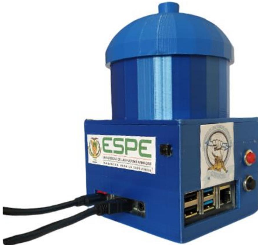
El computador o dispositivo externo y la nariz electrónica deben conectarse a la misma red WiFi, al conectar esta última se genera una dirección IP que es la necesaria para completar el enlace a través del Node Red.
