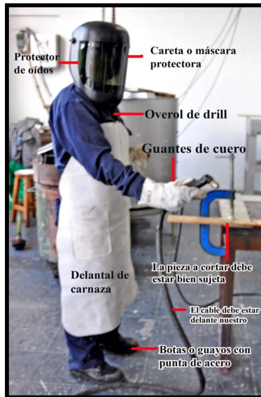
Figura 2.18. Equipo de protección personal para soldar
