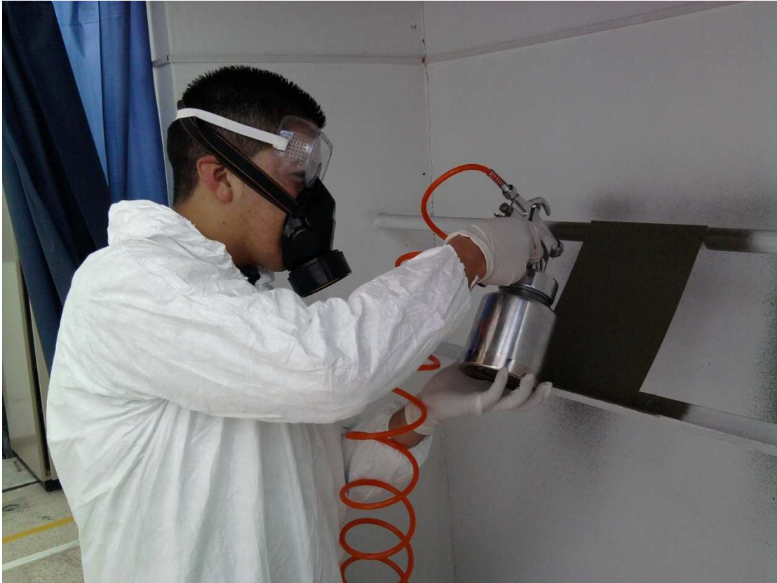
Figura 6.2. Prueba efectuada para la demostración de la utilización de pintura aeronáutica sobre la plancha de tol
