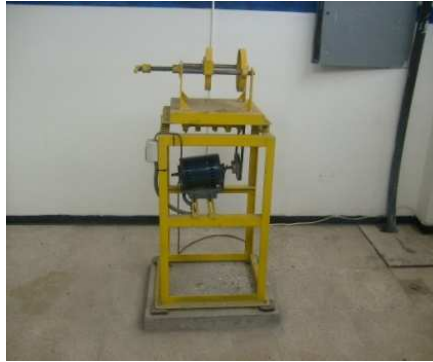
Figura 3.1. Agitador de pintura sin señalización.
