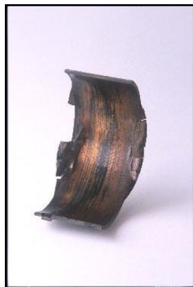
Figura 2.9 Fallo en el circuito de lubricación
