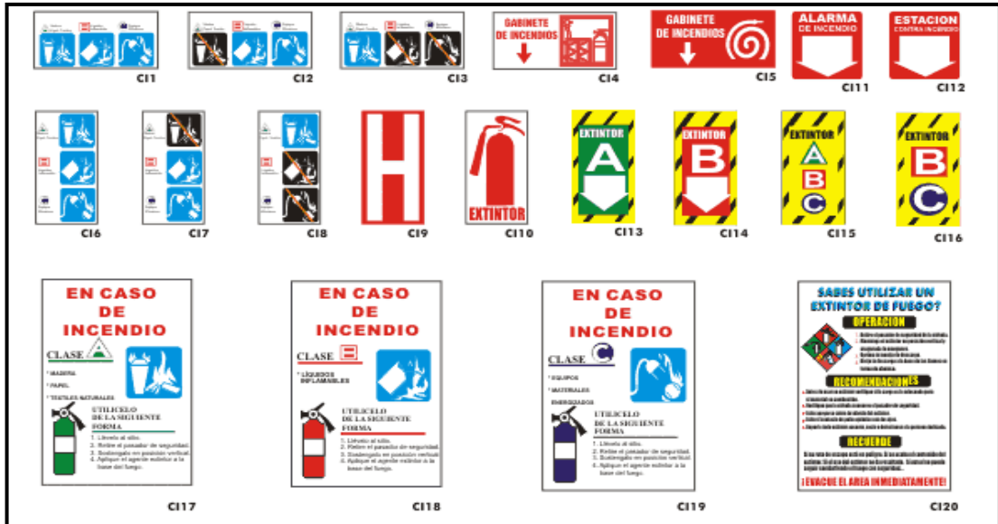
Figura 1.13. Señales contra incendio
