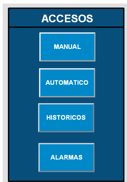
Figura 3. 33 Ventana de Navegabilidad Principal en HMI
