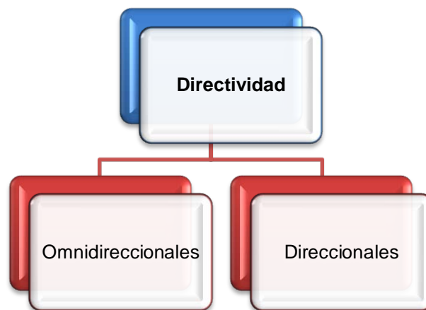
Figura. 1.16. Tipos de antenas por la directividad
