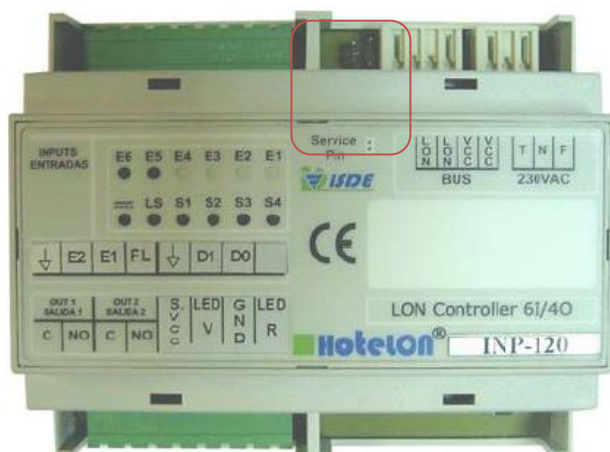
Figura 6.20. Identificación de pin de servicio de Nodo de Proximidad INP – 120F
