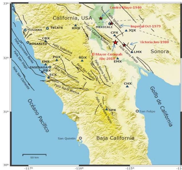
Figura 1 Mapa de las principales fallas de la región Norte de Baja California, localización del epicentro de acuerdo con RESNOM y estaciones acelerográficas, triángulos azules (Grupo RESNOM 2002).
