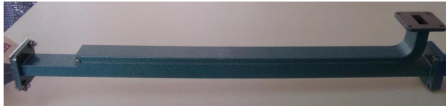
Figura. 3.21. Acoplador Direccional del Sistema de Entrenamiento a) Símbolo de Acoplador direccional, b) Imagen del Acoplador
