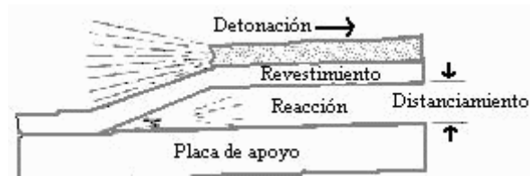
Figura 2.14 Ilustración de un proceso de soldadura por explosión
