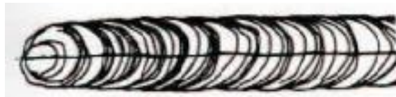
Figura 2.20 Rajaduras en el cordón
