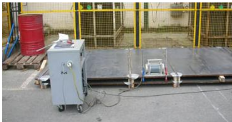
Figura 2.33 Aliviación de esfuerzos por medio de la aplicación de vibraciones
