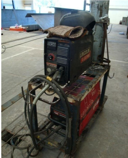
Figura 4.22 Soldadora Lincoln Electric Invertic V350-Pro
