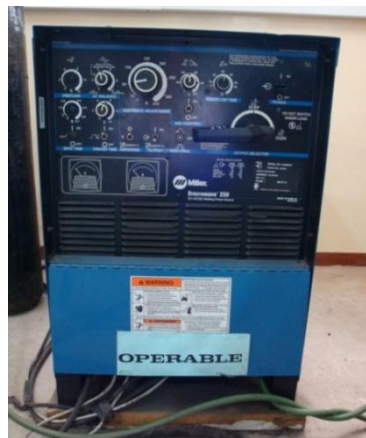
Figura. 4.24 Soldadora Miller Syncrowave 250
