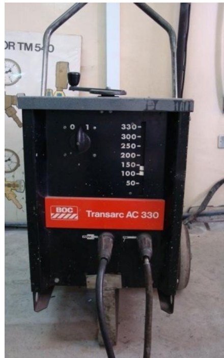
Figura 4.25 Soldadora BOC Transarc AC 330
