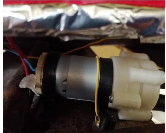
*Nota.* Esta figura muestra la implementación de la mini bomba de agua en la incubadora. En la figura 33 la sección (a) muestra dónde está ubicada la mini bomba de agua. En la figura 33 la sección (b) muestra un acercamiento de la mini bomba de agua.
