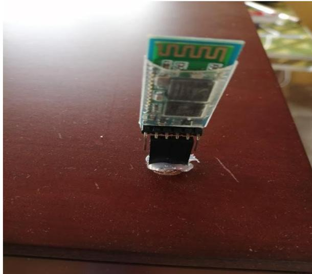
*Nota.* Esta figura muestra la implementación del módulo bluetooth HC-06 en la incubadora
