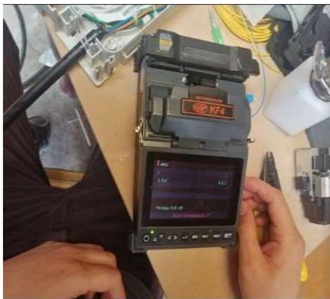
*Nota.* En la figura se representa el resultado obtenido al momento de fusionar dos cables, dando 0.1 dB de perdida.
