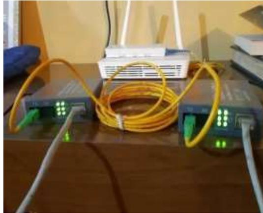
*Nota.* Se muestra el dispositivo que permitirá convertir la señal óptica del cable de fibra a señal eléctrica con cable de cobre o viceversa. Tomado de: (Oñate, 2016)
