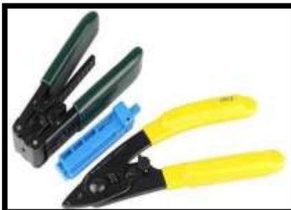
*Nota. En esta ilustración se observa la peladora y la cortadora que se utiliza para el cable de fibra óptica.*
