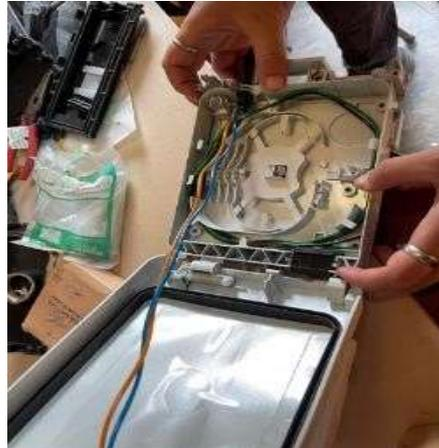
*Nota.* En la presente figura se muestra la parte interna del dispositivo mejor conocido como ODF, y la posición en la que fueron colocados los diferentes buffers.
