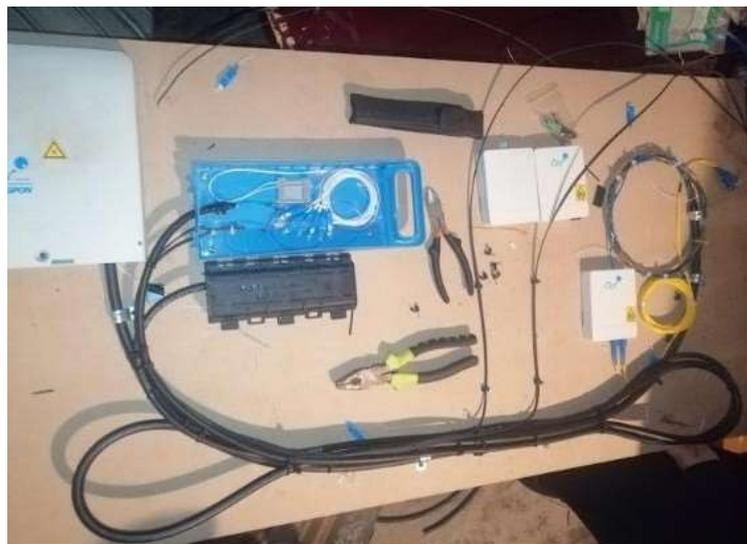
*Nota.* Se muestra la instalación de las rosetas en el proyecto, en donde se utilizará para el sistema FTTH del módulo.
