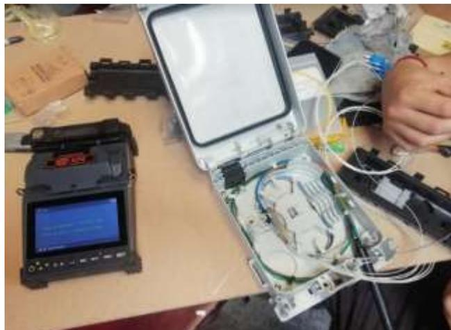
*Nota.* En esta imagen se puede observar cómo se realiza la multiplexación de la red, en donde se capacita el cableado de los 6 buffers y así completar a los 8 hilos.
