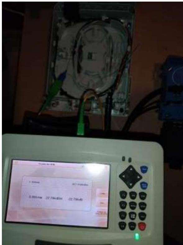
*Nota.* Se muestra la medición de la potencia (dB) dentro de la FDF sobre el funcionamiento al módulo.
