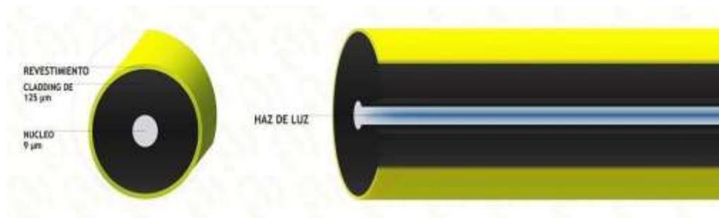
*Nota.* En la figura se encuentra la fibra monomodo y las partes que contiene la misma. Tomado de: <https://beyondtech.us/blogs/beyondtech-en-espanol/diferencias-entre-cables-de-fibra-optica-monomodo-y-multimodo>.
