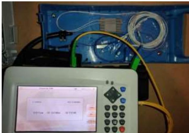
*Nota.* Se muestra la medición de la potencia (dB) dentro de la Roseta sobre el funcionamiento al módulo.
