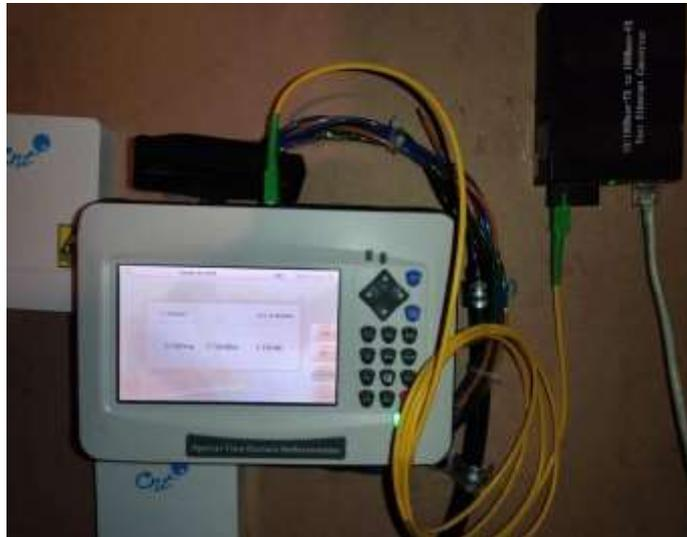
*Nota.* Se muestra la primera medición de potencia(dB) en el transceiver de entrada de potencia.
