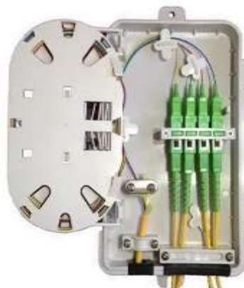
*Nota.* En la figura se muestra la parte interna de una caja terminal de fibra óptica y los elementos que lo componen. Tomado de: (Florida, 2019)
