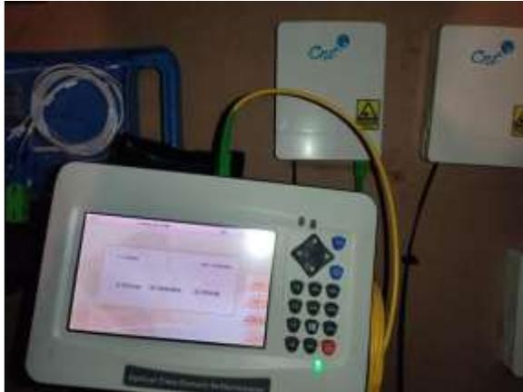
*Nota.* Se muestra la medición de la potencia (dB) dentro de la NAP sobre el funcionamiento al módulo.
