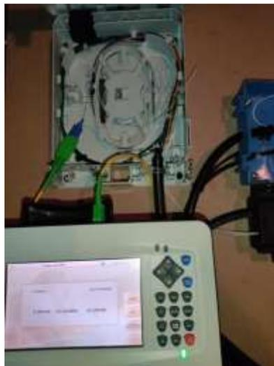
*Nota.* Se muestra la segunda medición de potencia (dB) en la caja de distribución que se utilizara en el módulo.
