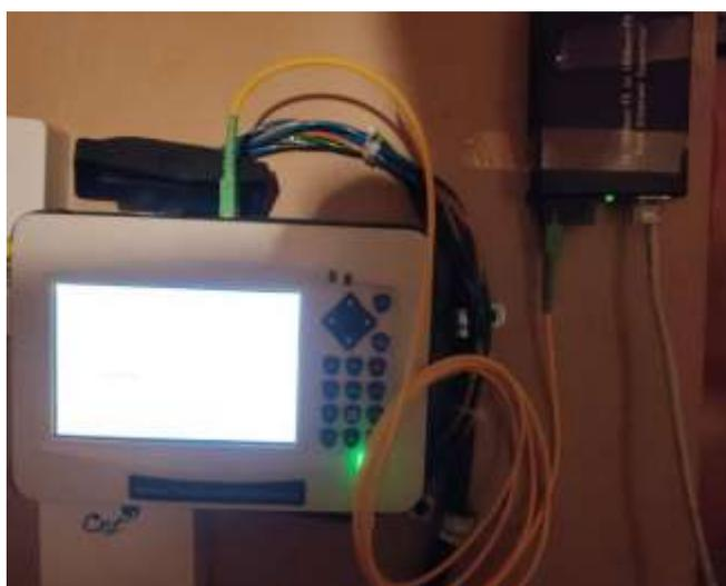
*Nota.* Se muestra la segunda medición de potencia (dB) en el transceiver de entrada de potencia.
