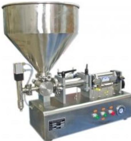
Figura 2.7: Maquina Dosificadora Automática
