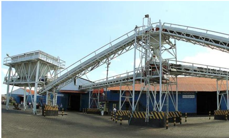
Figura 2.4: Banda Transportadora Industrial
