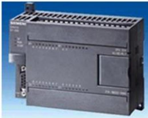
Figura 4.19: Controlador Lógico Programable Utilizado
