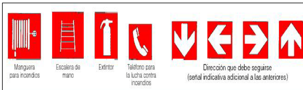
Figura 5.13 Señales relativas a equipos de lucha contra incendios
