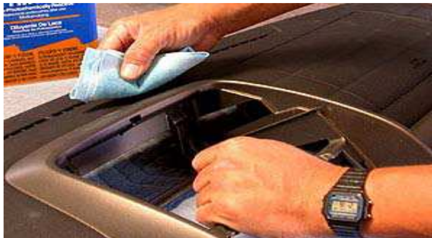
Figura 2.10 Preparación de la superficie
