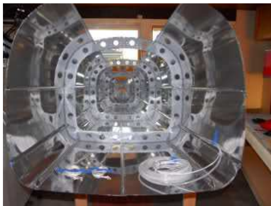
Figura 2.5 Fuselaje monocasco real
