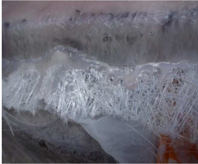
Figura 3.12 Fibra de vidrio con resina
