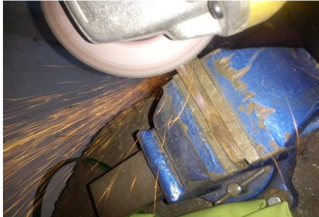
Figura 3.9 Corte de las ranuras en los circulares
