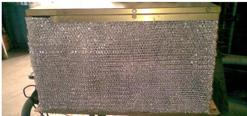
FIGURA 3.15 Colocación del filtro
