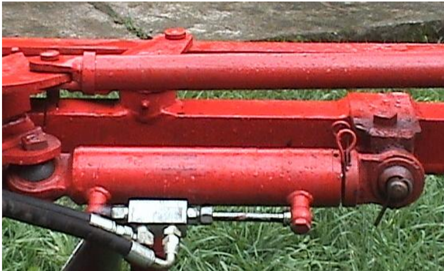
Figura. 3.3. Montaje del Cilindro Hidráulico.
