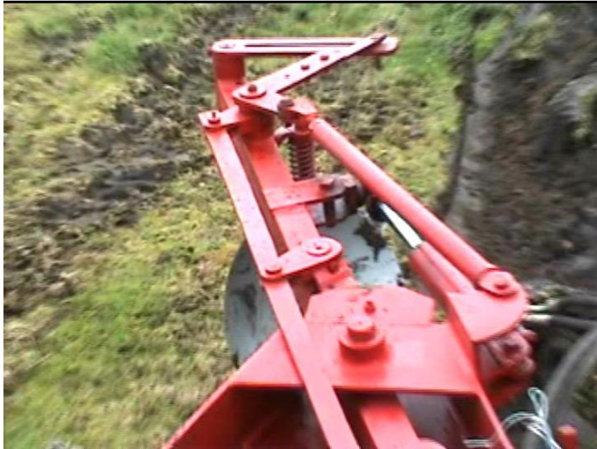
Figura 2. 9. Mecanismo de reversión de los discos.
