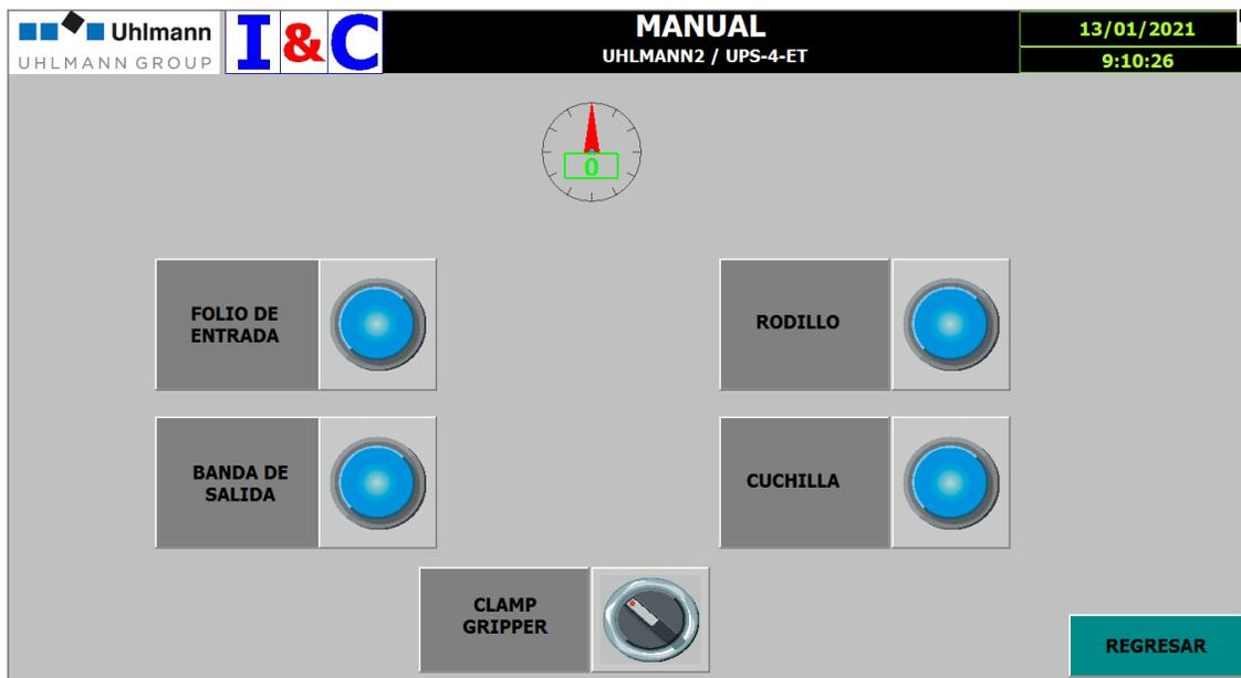
Se diseñó una sub-pantalla para electroválvulas en modo manual (figura 53), su activación es por medio de pulsadores los mismos que se activan de forma independiente, esta pantalla fue requerida para la realización de mantenimientos preventivos de la emblistadora. Cada pulsador tiene la descripción de la electroválvula de activación.
