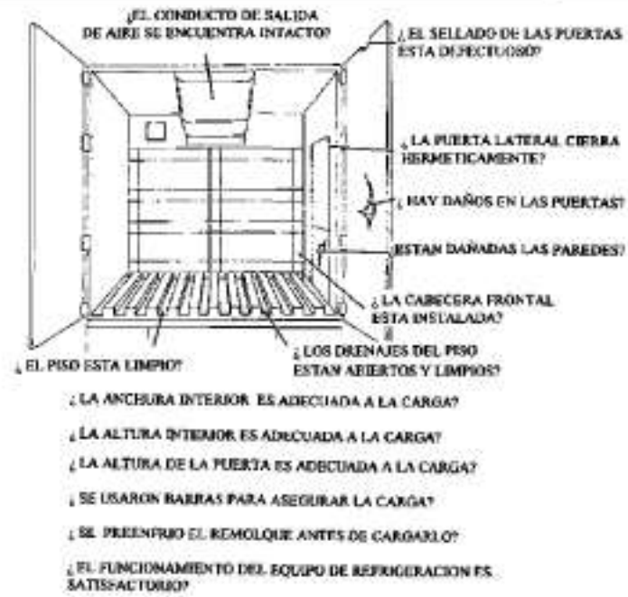
Figura 14. Controles en los sistemas refrigerados
