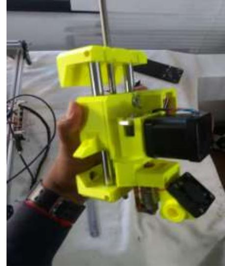
Armado de los componentes del eje z
