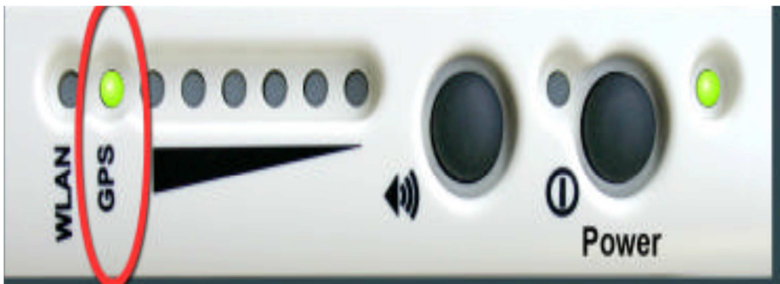
Figura 2.7 Indicadores del GPS del terminal BGAN 9201
