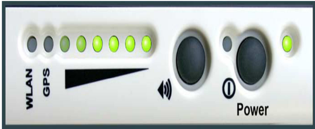
Figura 2.8 Sincronización del GPS del terminal BGAN 9201
