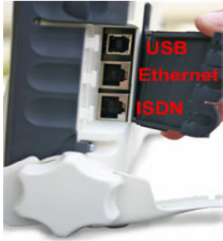
Figura 2.6 Puertos de la terminal BGAN 9201
