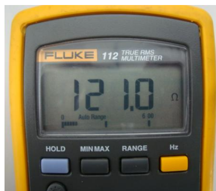
FIG. 3.10: Medición de la Resistencia Terminal
