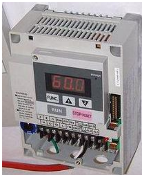
FIG. 1.21: Variador de velocidad electrónico
