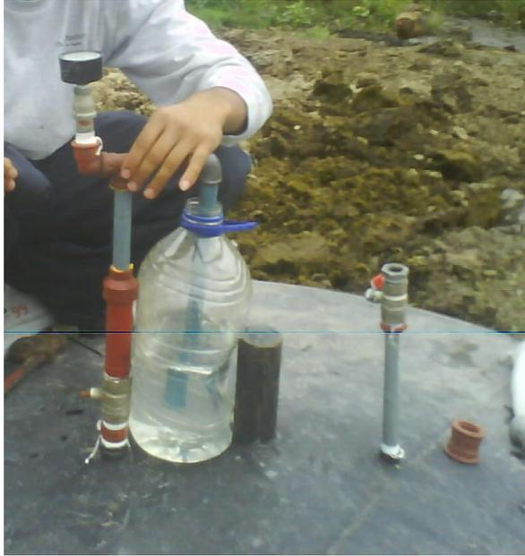
**Fotografía 7.6** Manómetros para la Medición de la Presión (Diferencial y Tubo de Bourdon)
