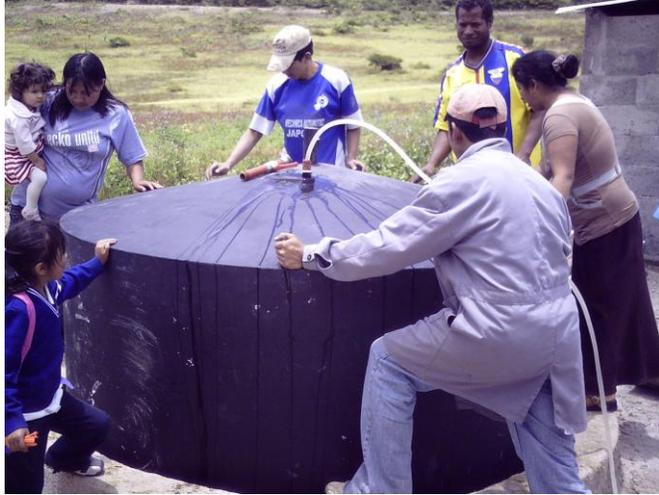
**Fotografía 7.5** Comprobación de la Hermeticidad del Gasómetro.
