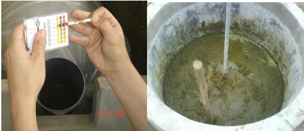
Fotografía 8.4: Medición del pH Dentro del Pozo.
