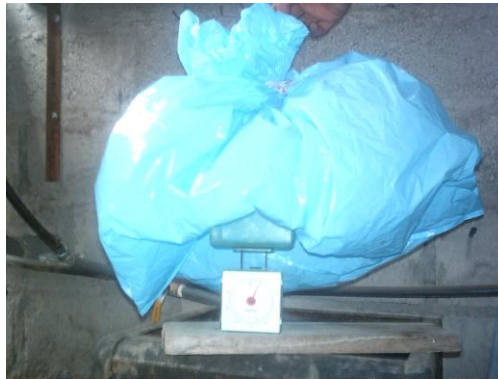
Fotografía 8.7: Peso del Recipiente Lleno de Biogás.
