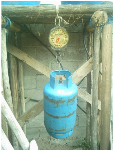
Fotografía 8.8: Peso del Tanque de GLP.
