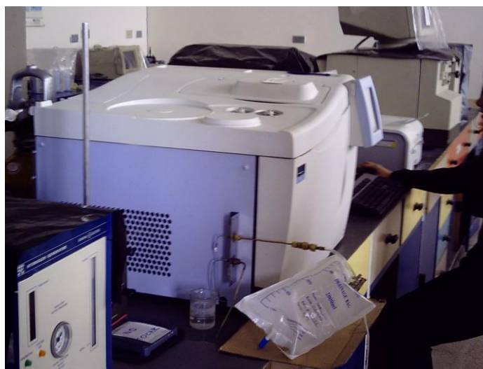
Fotografía 8.1: Cromatografo de Gases de EPN del Departamento de Ingeniería Química en el Laboratorio de Análisis Instrumental
