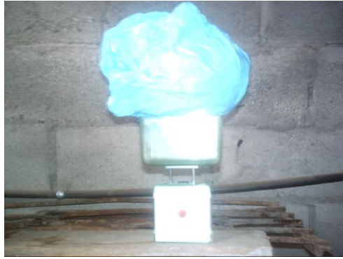
Fotografía 8.5: Peso del Recipiente Vacío para la Recolección del Biogás.
