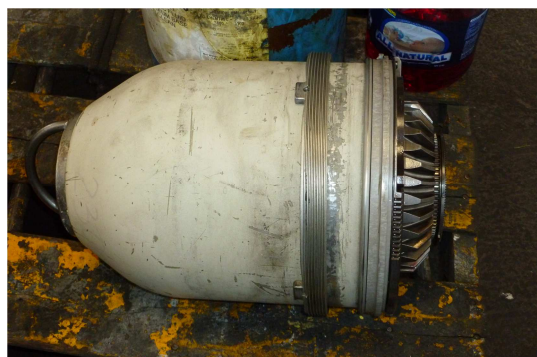
Figura 2.14: Conjunto del Domo o Cúpula parte externa.
