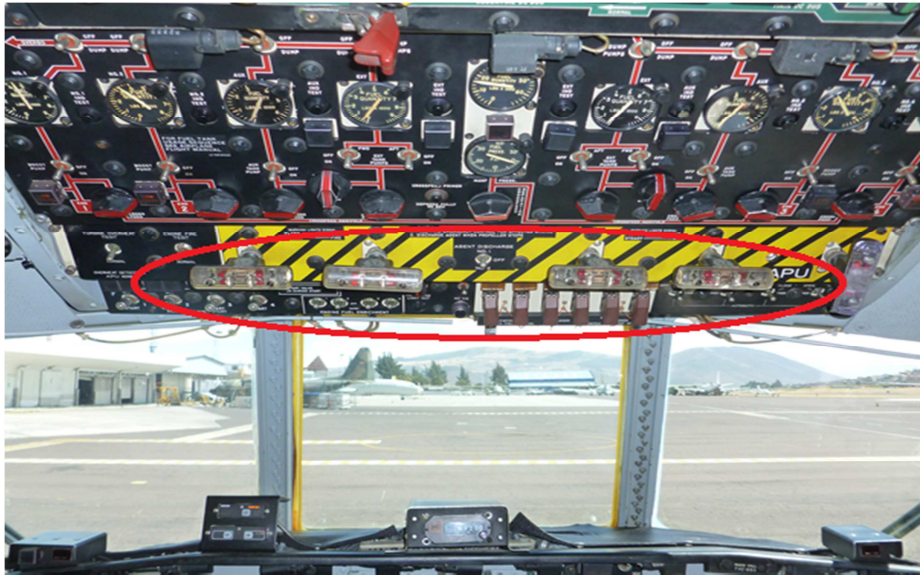
Figura 2.35: T-Handle del motor 1, 2,3 y 4 de izquierda a derecha.
