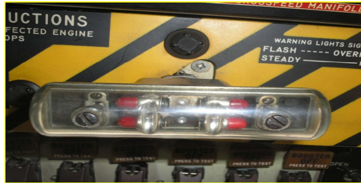
Figura 2.41: Luces de indicación de la T-Handle.
