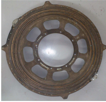
Figura 2.20: Vista frontal del conjunto de los anillos colectores.
