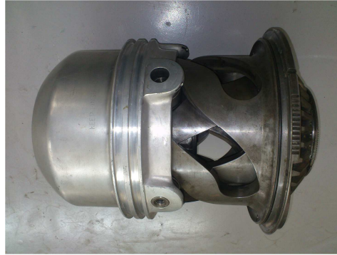
Figura 2.15: Conjunto del Domo o Cúpula parte interna.
