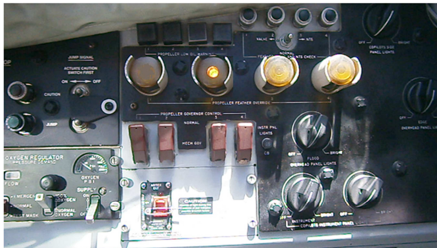
Figura 2.46: Luz de override de la hélice 2 en proceso de embanderamiento
