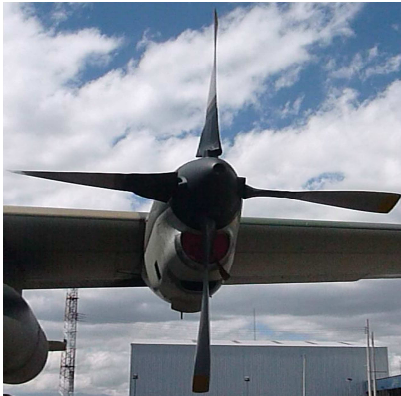
Figura 2.51: Posición de las palas en ángulo de bandera de la hélice N° 2 Fuente: Avión C-130H Ala de Transporte N° 11 Quito.
