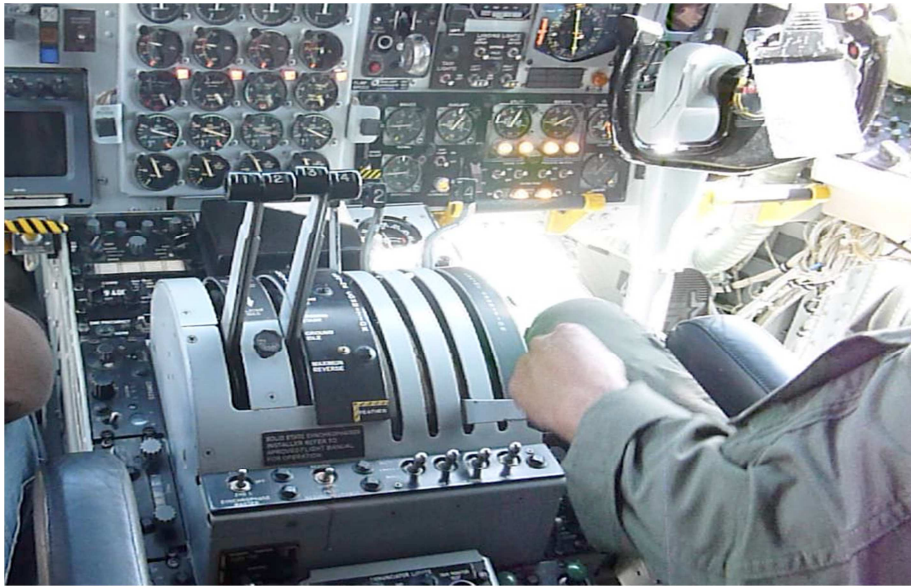
Figura 2.32: Posición FEATHER en las palancas de condición.
