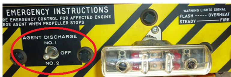
Figura 2.54: Switch del agente de descarga
