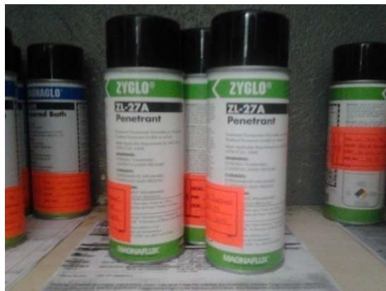
Fig. 4.2 Líquido Penetrante
