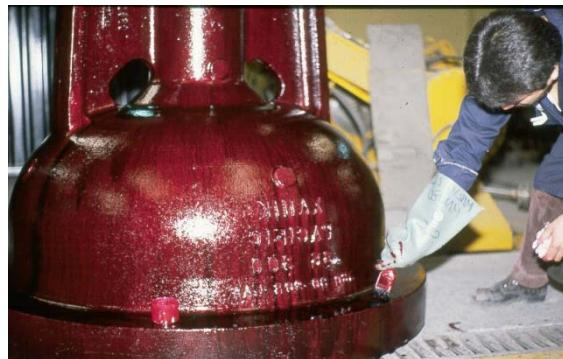
Figura 2.3 Examinación con penetrante visible
