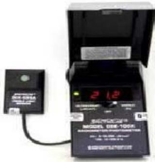
Figura 2.14 Medidor de intensidad de luz negra
