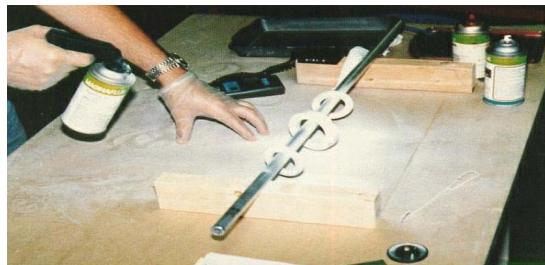
Figura 3.8 Aplicación del revelador
