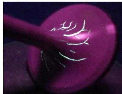
Figura 2.2 Examinación con penetrante Fluorescente
