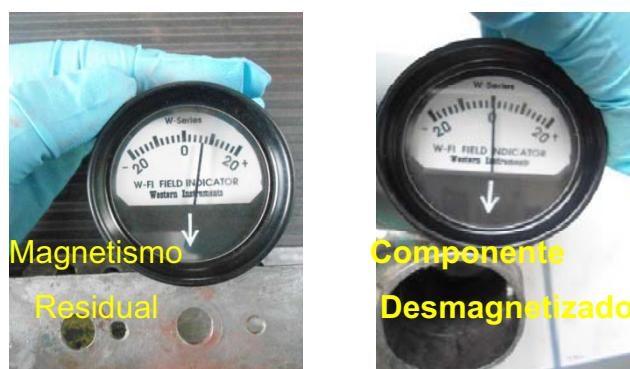
Figura 3.45 Comprobación de campo magnético residual
