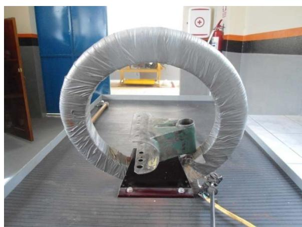
Figura 3.35 Magnetización con bobina
