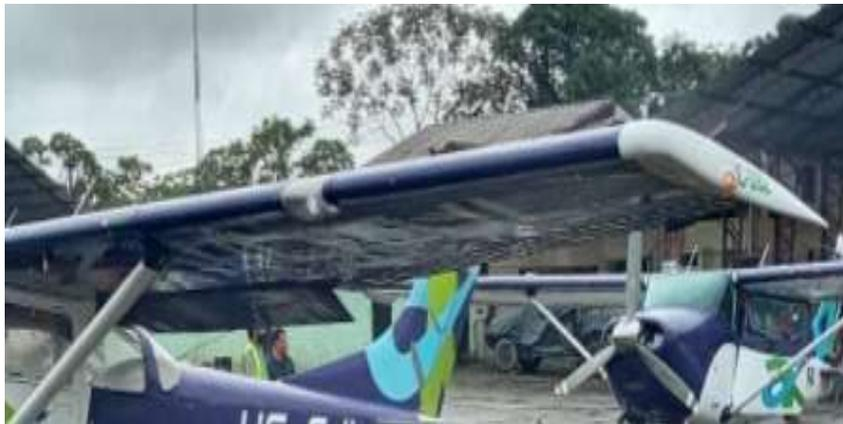
*Nota.* La imagen indica la parte frontal de una terminación de ala de tipo caídas la cual incorpora una luz de navegación. Tomado de ("AEROK", 2021)
