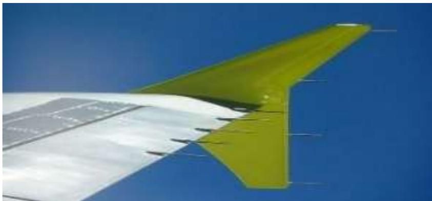
*Nota.* En la imagen se puede identificar una terminación de punta de ala de tipo winglet fence. Tomado de (EASBARCELONA, 2021)
