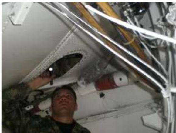
*Nota.* La imagen muestra una inspección visual con el uso de una linterna. Tomado de (ARENAS, s.f.)
