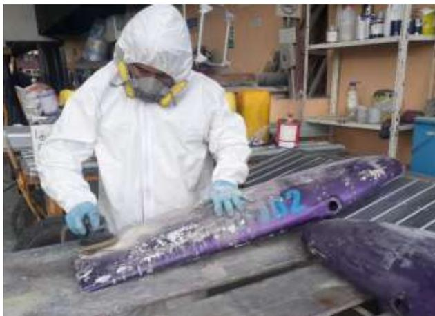
*Nota.* la imagen indica el proceso para eliminar los excesos de resina y fibra de vidrio después de la reparación.
