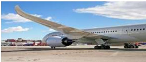
*Nota.* La imagen muestra la parte posterior de una punta alar de tipo raked wingtip. Tomado de (EASBARCELONA, 2021)
