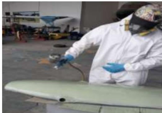
*Nota.* La imagen indica el proceso de aplicación de primer sobre la superficie del componente.
