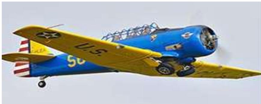
*Nota.* En la imagen indica una aeronave con ala de tipo plano bajo. Tomado de (Navarro, s.f.)
