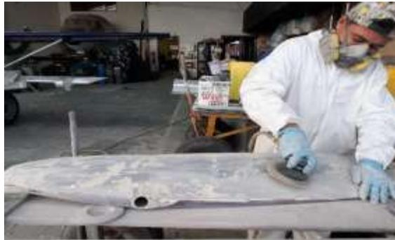
*Nota.* La imagen indica el proceso de lijado hasta lograr una superficie lisa y sin imperfecciones.
