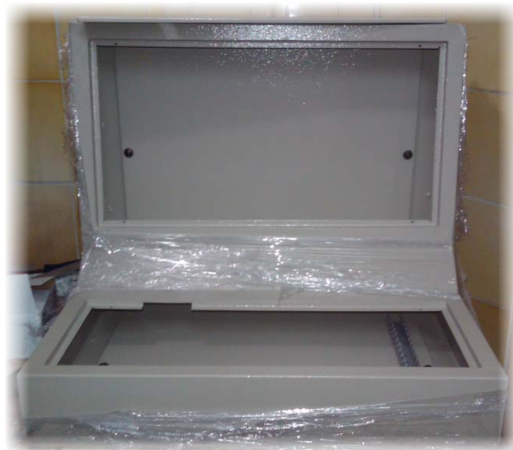
Figura 6.2. Gabinete fabricado para el Sistema de Entrenamiento Insteon
