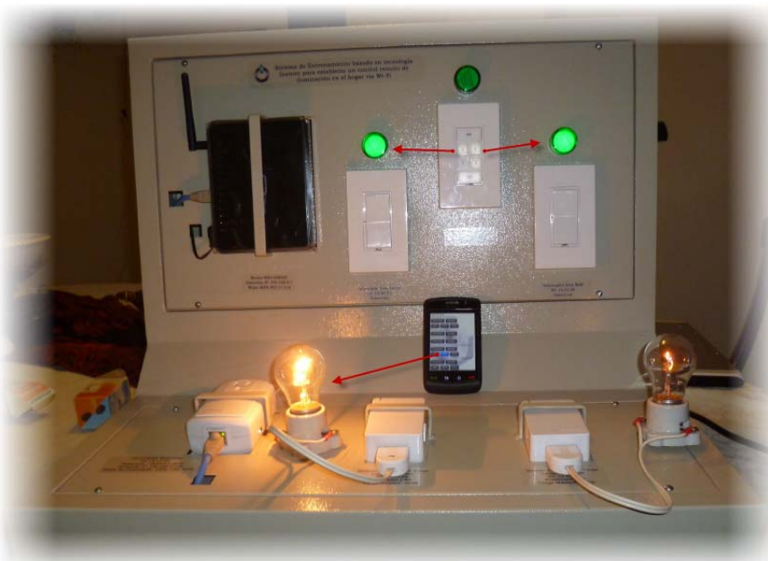
Figura 6.33. Prueba de Funcionamiento con la aplicación BlackBerry
