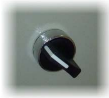
Figura 6.8. Selector de dos posiciones Telemecanique para energizar el Sistema
