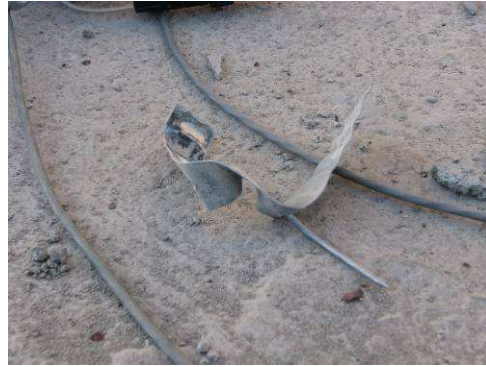
Figura 11 Conector típico del lado sur, con deformación cortante (segundo 2.0 Sylmar, >MCE)
