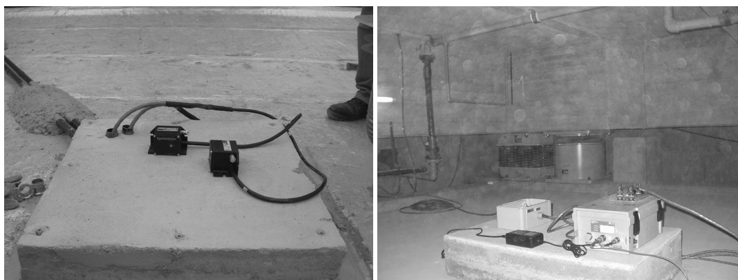
Figura 45 Bases de hormigón simple para fijar el instrumental de medición
