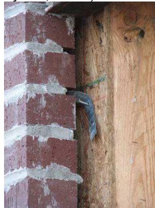
Figura 13 Extracción de clavos, esquina noreste (segundo 2.0 Sylmar, >MCE)
