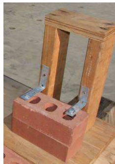
conectores corrugados (izquierda) y rígidos (derecha)
