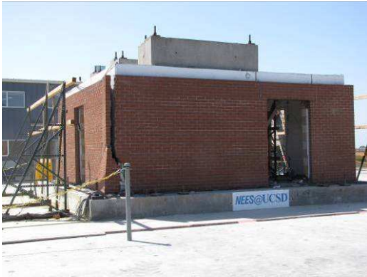
Figura 22 Daños a fachada en la esquina noreste y el lado este luego de la segunda corrida de 1.50 Tarzana
