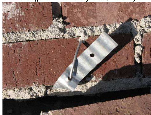
Figura 9 Conector típico del lado sur (segundo 2.0 Sylmar, >MCE)
