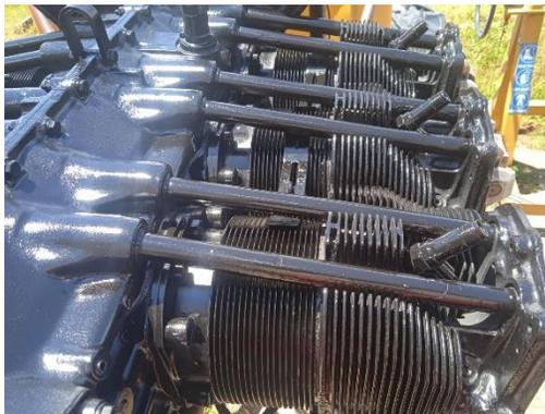
*Nota.* Se instaló las bujías para finalizar la preservación del motor.
