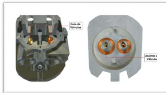
*Nota.* Cabeza de un cilindro con sus guías de válvulas. Tomado de Área Departamental Aeronáutica (s.f.)
