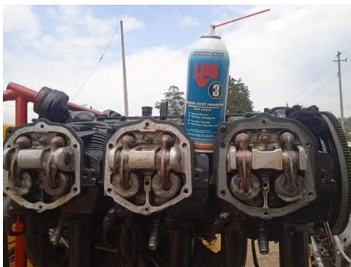
*Nota.* Colocación de un inhibidor de corrosión en partes del cilindro.
