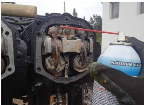
*Nota.* Componentes del cilindro rociado con inhibidor de corrosión.
