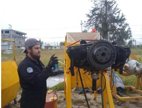
*Nota.* Se roció con inhibidor de corrosión los componentes del motor.
