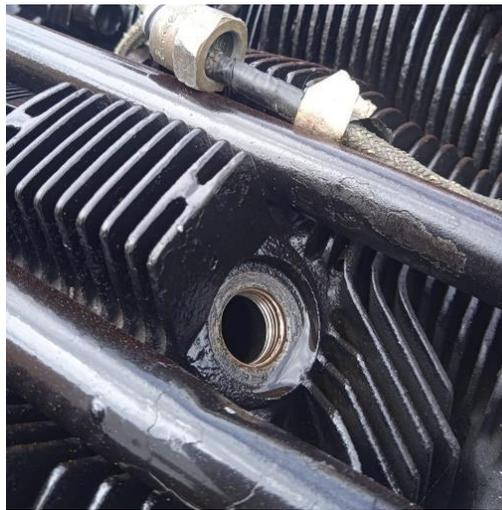
*Nota.* Rociado con inhibidor de corrosión LPS3 para preservar los componentes.
