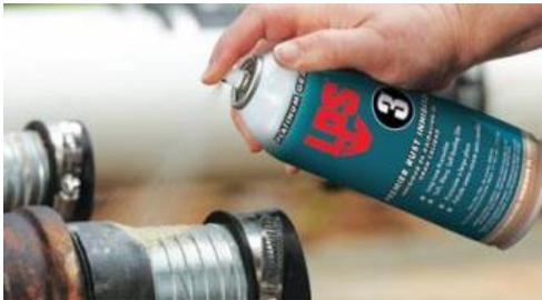
*Nota.* Aplicación de un inhibidor de corrosión. Tomado de Federal Aviation Administration. (2018).
