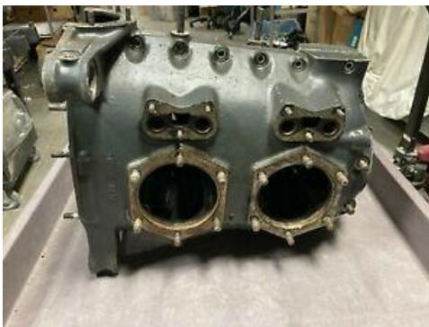
*Nota.* Block de un motor fabricado en acero de fundición. Tomado de Área Departamental Aeronáutica (s.f.)
