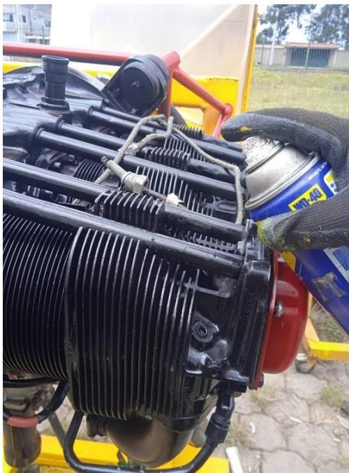
*Nota.* Rociado de los componentes internos del motor.
