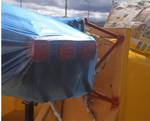
*Nota.* Tratamiento con pintura roja del montante del motor.
