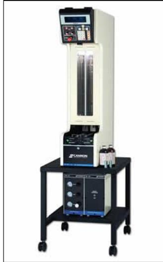
**Figura 2.9** Viscosímetro automático<sup>4</sup>
