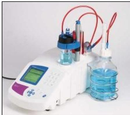
**Figura 2.10** Equipo titulación potenciométrica<sup>5</sup>
