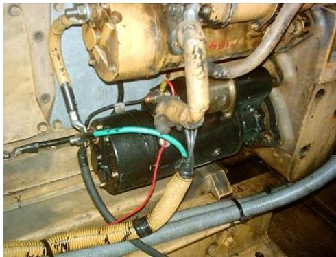
**Figura 4.5** Conexión eléctrica del calefactor
