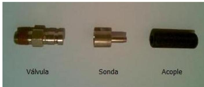
**Figura 3.4** Válvula de muestreo y accesorios
