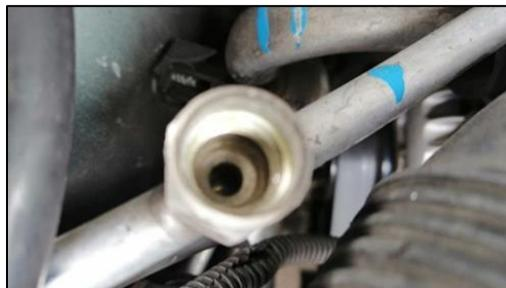
*Nota.* Se llevó a cabo la limpieza de las tomas de carga del sistema de aire acondicionado, tanto de forma interna como externa.
