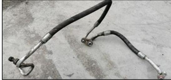
*Nota.* Las cañerías luego de realizar el mantenimiento interno y limpieza exterior.
