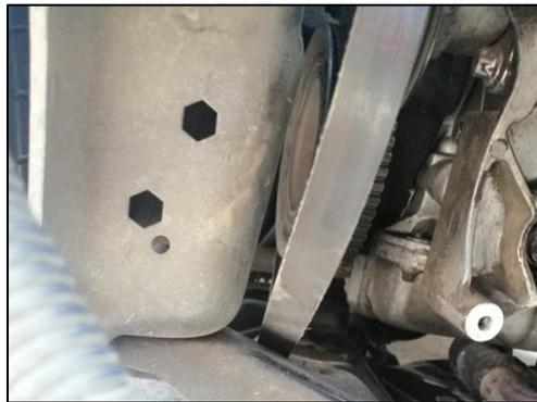
*Nota.* Se desconecta la banda de transmisión de potencia para poder retirar el compresor.
