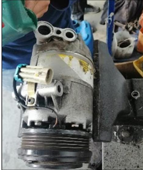
*Nota.* Se muestra la colocación de aceite en la toma de alta presión, debido a que en este tipo de compresor no cuenta con tapón de llenado.
