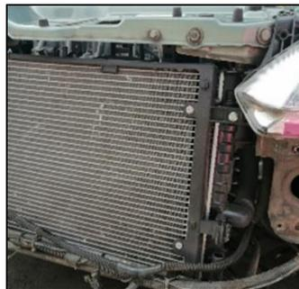
*Nota.* Se retira el parachoques del vehículo para acceder con mayor facilidad a los componentes del sistema de aire acondicionado del automóvil.
