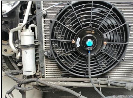
*Nota.* Se muestra la instalación completa del electroventilador del condensador, con todos sus elementos ajustados y listos para ponerse en marcha.
