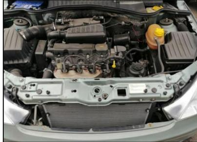
*Nota.* Los mejores sitios de acceso para desmontar los componentes del sistema de aire acondicionado Automotriz en este vehículo son el parachoques y el capote.
