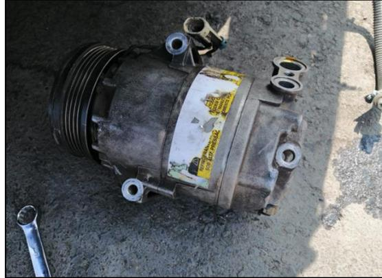
*Nota.* Se extrae el compresor del sistema con el fin de analizar su estado y condición.
