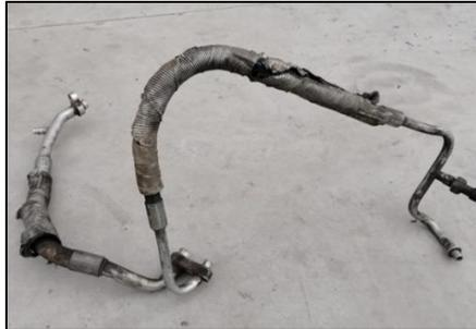
*Nota.* Se extrae este segmento de cañerías de baja y alta presión del sistema con el fin de analizar su estado y condición.
