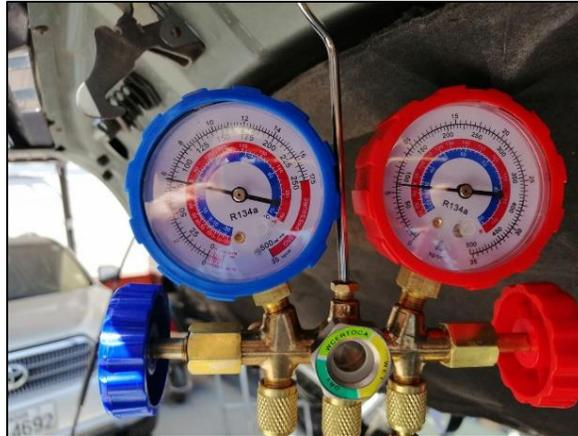
*Nota.* Se muestra la medición de baja presión utilizando los manómetros.
