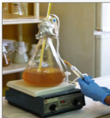
Fotografía H.6 Toma de muestra del Bioacaricida producido a escala 1 L. Hilsea, Quito, Pichincha, 2010
