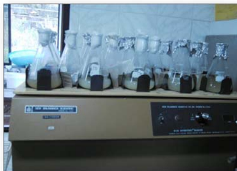
Fotografía H.3 Fermentaciones de los cuatro medios de cultivo (M1, M2, M3, M4) con las diferentes concentraciones de inóculo ( 1 \times 10^7 , 1 \times 10^8 , 1 \times 10^9 UFC/ ml). Hilsea, Quito, Pichincha, 2010
