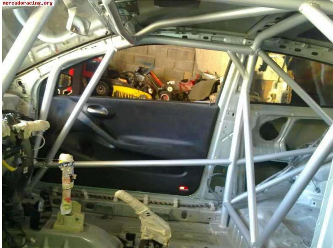
Para unir los tubos de la jaula de seguridad se debe seleccionar correctamente el material y sus distintas herramientas para la soldadura con un alambre de aporte #8
