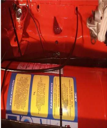
Instalación del cable de accionamiento
