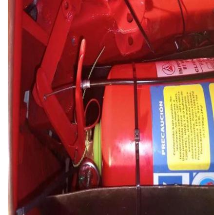
Instalación de cañerías en la cabina del vehículo
