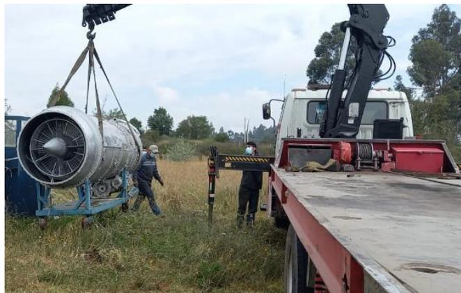
Para el traslado del motor se rentó una grúa con una capacidad de hasta 10 toneladas. El motor fue sujeto por el mismo brazo hidráulico y a la vez se trasladó en la cama baja de la misma grúa.
