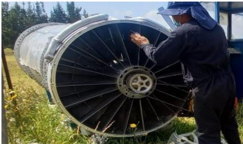
*Nota.* En la figura se observa la inspección preliminar que se realizó al motor, encontrando diferentes anomalías principalmente corrosión.
