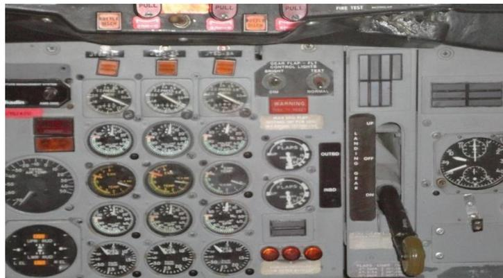
*Nota.* Se muestra el sistema de indicación de los Motor –P2. Tomado de (FEDEX, 2010)
