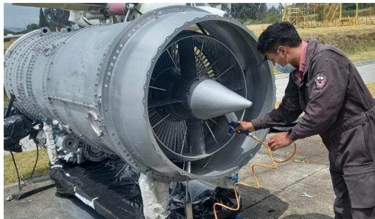
*Nota.* En la figura se observa el proceso de limpieza final exterior y interior motor.
