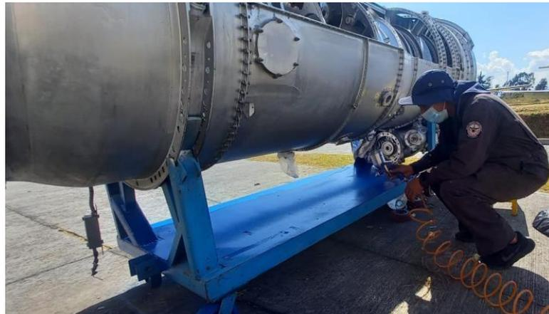
*Nota.* En la figura se observa el proceso de pintura a la base del motor.
