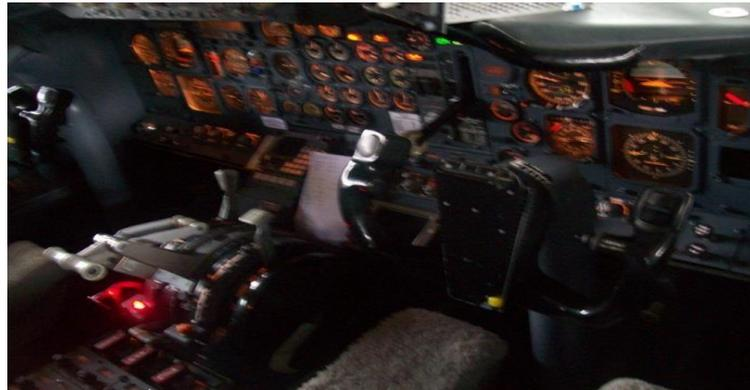
*Nota.* Se muestran la palanca del control del Motor JT8D. Tomado de (FEDEX, 2010)
