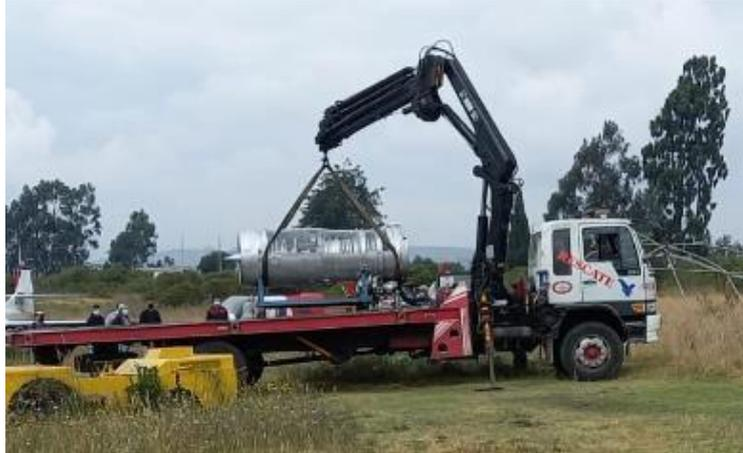
*Nota.* En la figura se observa el traslado del motor hacia un lugar donde se pueda realizar un mantenimiento adecuado.
