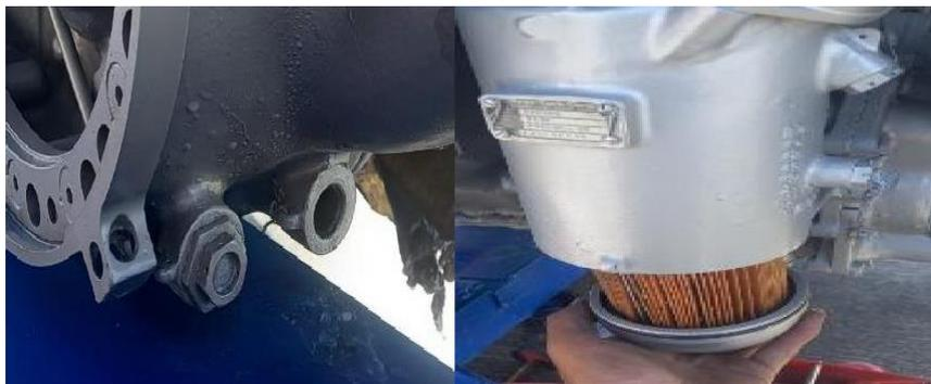
*Nota.* En la figura se observa el proceso del cambio del filtro de combustible.
