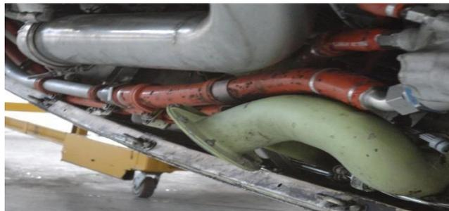
*Nota.* Se muestran Drenaje del Motor JT8D. Tomado de (FEDEX, 2010)
