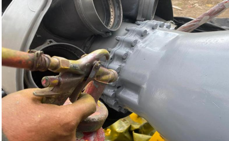
*Nota.* El gráfico representa el proceso de pintado, utilizando la técnica de pulverizado.
