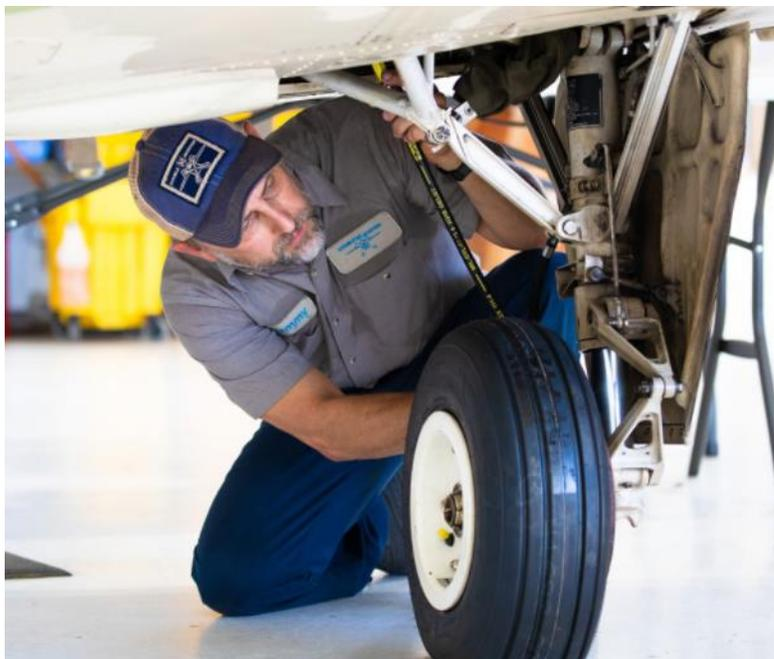
*Nota.* El gráfico representa a la revisión del tren de aterrizaje dentro de la inspección de 100 horas. Tomado de (Aviation D. M., 2017).
