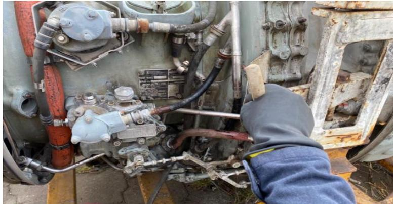
*Nota.* El gráfico representa a la remoción mediante un raspador de la corrosión que se encontraba en los componentes del motor.
