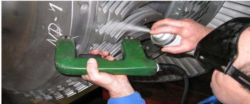
*Nota.* El gráfico representa la aplicación del método de inspección por partículas magnéticas a un componente del motor. Tomado de (TÜV, 2016).
