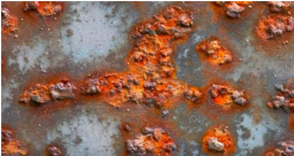
*Nota.* Este gráfico representa la aparición de corrosión tipo intergranular sobre una superficie de metal. Tomado de (Industria, 2019).
