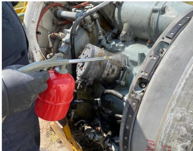
*Nota.* El gráfico representa el pulverizado de los componentes del motor para remover la grasa adherida.
