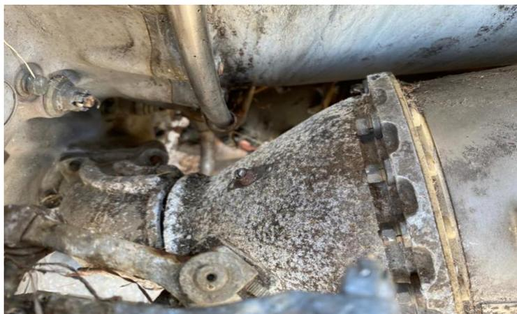
*Nota.* El gráfico demuestra la presencia de corrosión galvánica en la cámara de expansión, producida por permanecer en la intemperie.
