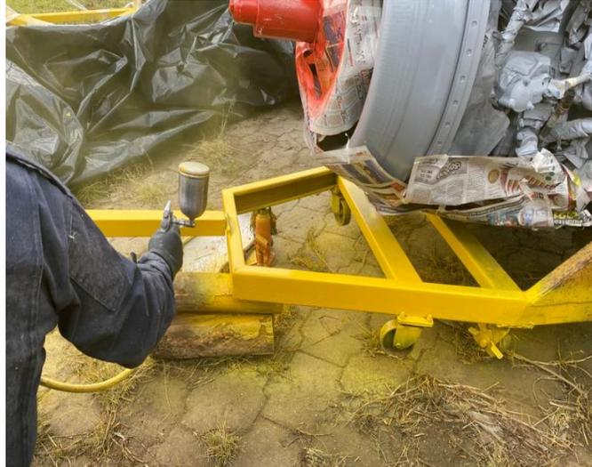
*Nota.* El gráfico representa el proceso de pintado a los montantes del motor, utilizando la técnica de pulverizado.
