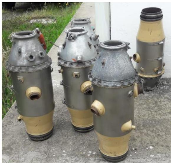
*Nota.* El gráfico representa a las cámaras de combustión desmontadas del motor.
