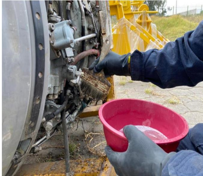
*Nota.* El gráfico representa la limpieza externa de los componentes del motor utilizando desengrasante.
