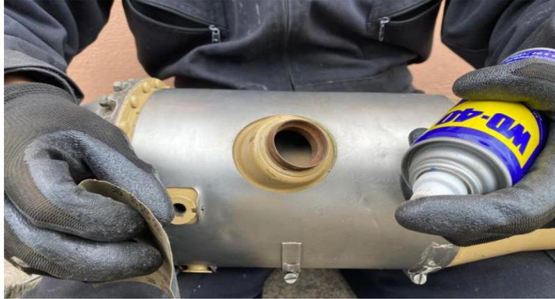
*Nota.* El gráfico representa la limpieza de la cámara de combustión utilizando lija y WD-40 para remover el óxido de las partes metálicas.
