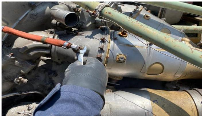
*Nota.* El gráfico representa la remoción de las tuercas correspondiente a la conexión del quemador de la cámara de combustión.
