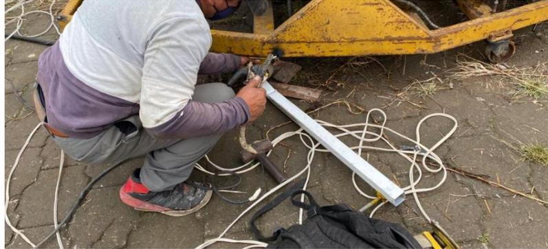
*Nota.* El gráfico representa el proceso de suelda de las nuevas ruedas en el montante del motor.
