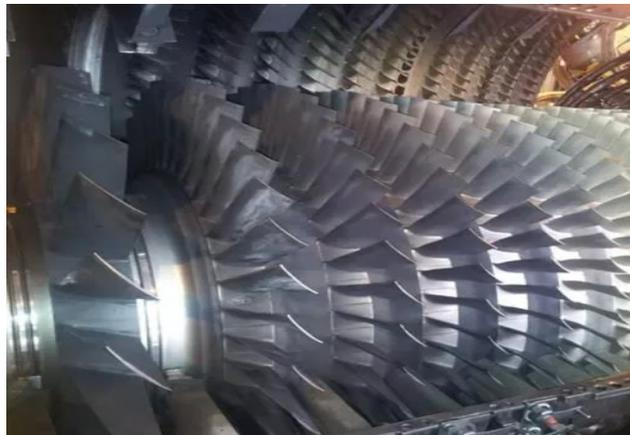
*Nota.* El gráfico representa a la sección del compresor de un motor a turbina. Tomado de (Alamy, 2017).
