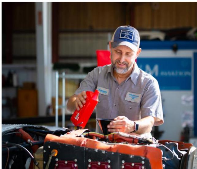
*Nota.* El gráfico representa al cambio de aceite del motor dentro de la inspección de 50 horas. Tomado de (Aviation D. M., 2017).
