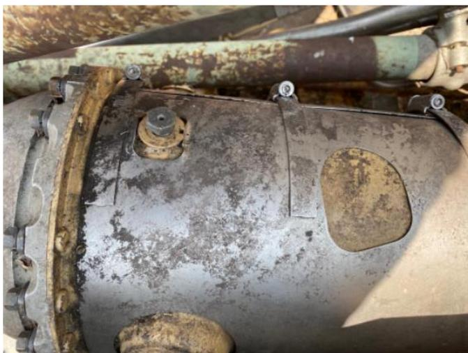
*Nota.* El gráfico demuestra la presencia de polvo y grasa en la cubierta de aire de la cámara de combustión del motor.
