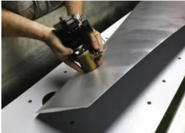
*Nota.* El gráfico representa a la aplicación de una inspección por el método de ultrasonido a una estructura compuesta de la aeronave. Tomado de (Machado's, 2016).
