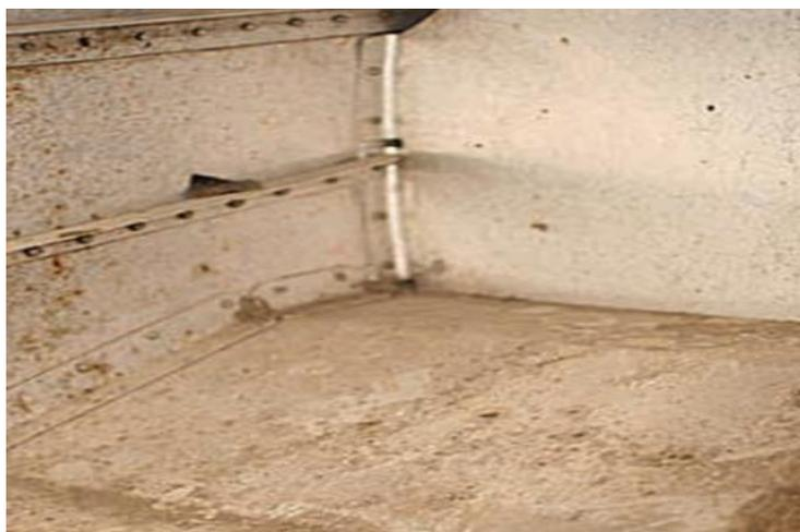
*Nota.* El gráfico representa la presencia de corrosión por ataque químico directo en un compartimiento de batería. Tomado de (FAA, 2018).
