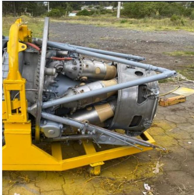
*Nota.* El gráfico representa las cámaras de combustión instaladas correctamente en el motor Rolls Royce Dart MK.
