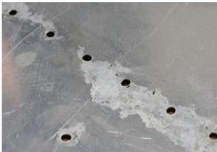
*Nota.* El gráfico representa a un material compuesto afectado por corrosión superficial. Tomado de (Alamy, 2017).
