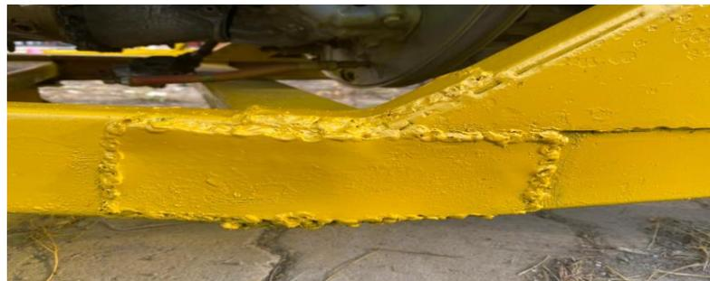
*Nota.* El gráfico representa la lámina de refuerzo que se colocó en la base de los montantes del motor.
