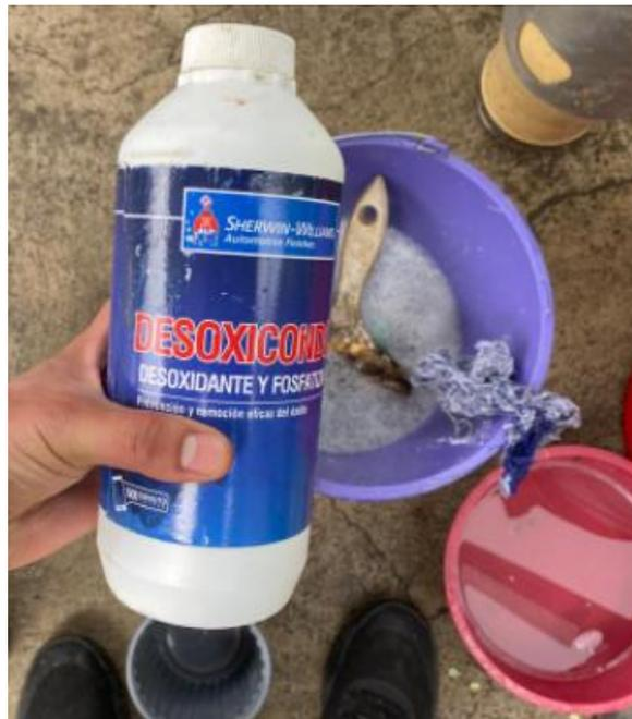
*Nota.* El gráfico representa la solución que se utilizó para remover las partes del motor que se encontraban con óxido.
