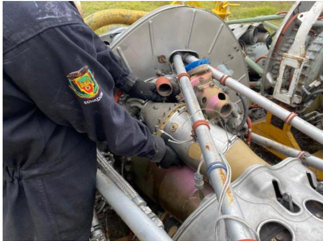
*Nota.* El gráfico representa el desmontaje de las cámaras de combustión correspondiente al motor Rolls Royce Dart MK 551.
