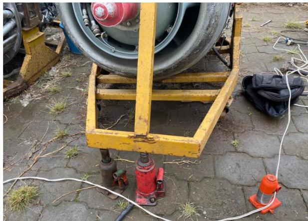
*Nota.* El gráfico representa el proceso de elevación de los montantes del motor mediante el uso de gatas hidráulicas.
