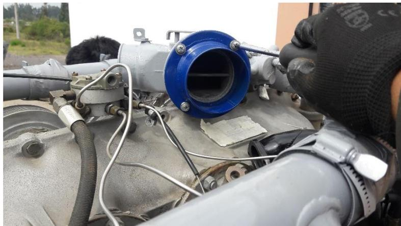
*Nota.* Esta figura representa la instalación del filtro de aire del Motor Continental IO-360-D (21).
