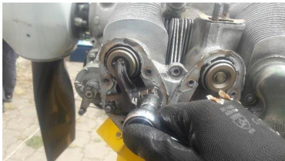
*Nota.* Esta figura representa la instalación del conjunto de válvulas del cilindro 6 del Motor Continental IO-360-D (21).
