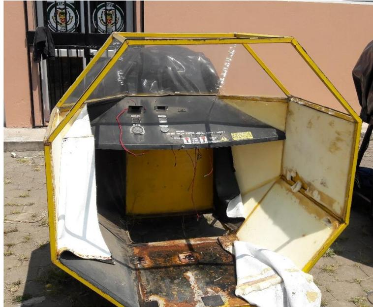
*Nota.* Esta figura representa el desmontaje del asiento y forros de la cabina del banco de prueba del Motor Continental IO-360-D (21).
