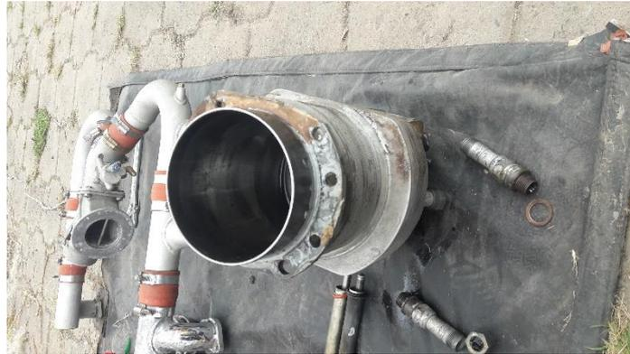
*Nota.* Esta figura representa la inspección de fugas posibles en el cilindro 6 del Motor Continental IO-360-D (21).
