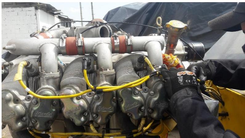
*Nota.* Esta figura representa la revisión de la instalación de la bujía de los cilindros.
