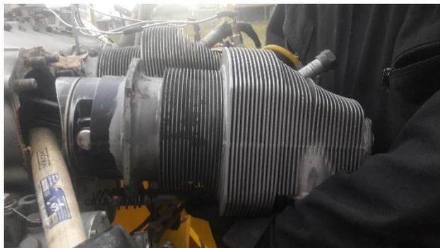
*Nota.* Esta figura representa la desmontada del cilindro 6 del Motor Continental IO-360-D (21).
