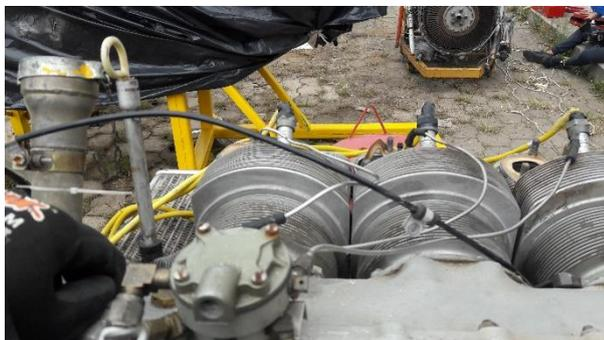
*Nota.* Esta figura representa la inspección de fugas del sistema de inyección de combustible del Motor Continental IO-360-D (21).
