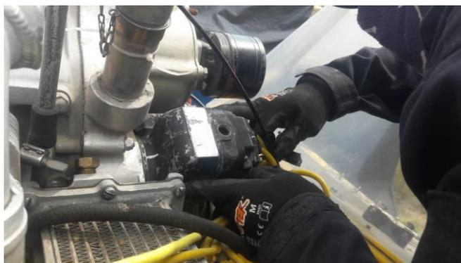
*Nota.* Esta figura representa la inspección del magneto del motor Continental IO-360-D (21).
