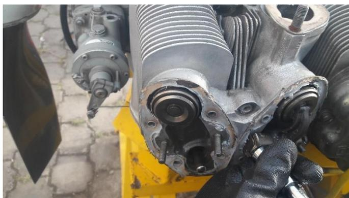
*Nota.* Esta figura representa la retirada de las válvulas del cilindro 6 del Motor Continental IO-360-D (21).
