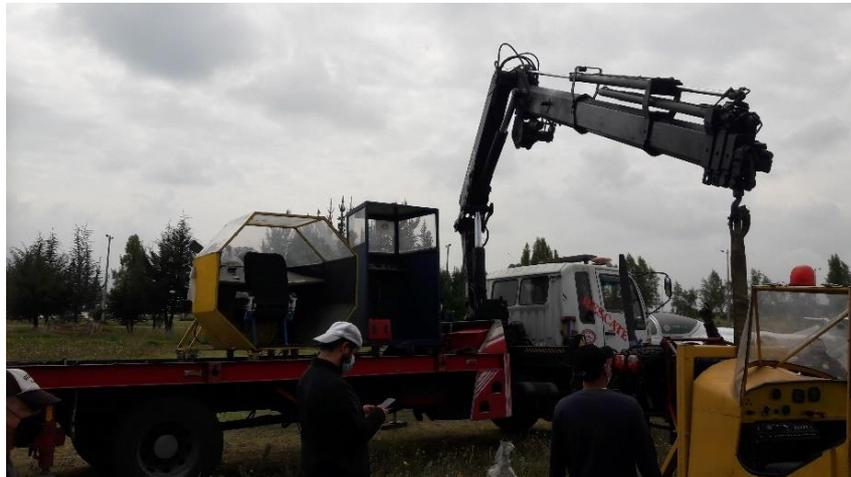
*Nota.* Esta Figura representa el traslado del motor Continental IO-360-D (21) con la grúa tipo plataforma hacia la parte trasera de los laboratorios de Mecánica Aeronáutica.
