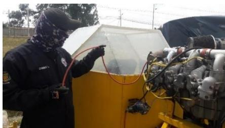
*Nota.* Esta figura representa la inspección del sistema eléctrico para seguir las del Motor Continental IO-360-D (21).
