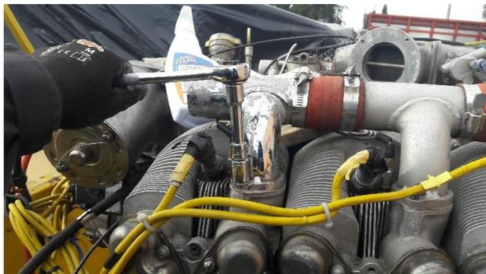
*Nota.* Esta figura representa el desmontaje de los tubos de admisión de aire del Motor Continental IO-360-D (21)
