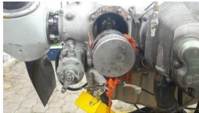
*Nota.* Esta figura representa cubierta del cilindro del cárter.
