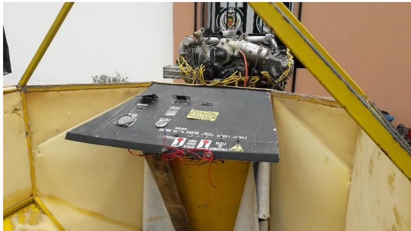
*Nota.* Esta figura representa el corte realizado al panel de control de la cabina del banco de prueba del Motor Continental para poder disminuir las dimensiones de la cabina.
