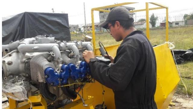
*Nota.* Esta figura representa el ingreso de la sonda del boroscopio hacia el cilindro por medio del orificio de la bujía superior.
