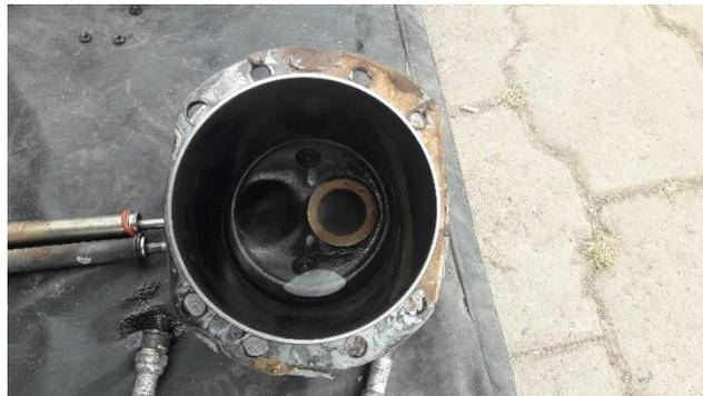
*Nota.* Esta figura representa la prueba hidrostática del cilindro 6 del Motor Continental IO-360-D (21).
