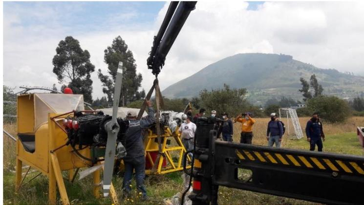
*Nota.* Esta figura representa el Motor Continental IO-360-D (21) anclado con el brazo Hidráulico de la grúa tipo plataforma para su traslado.
