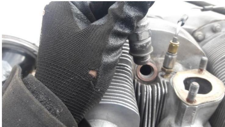
*Nota.* Esta figura representa una bujía desmontada del Motor Continental IO-360-D (21).
