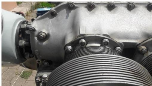
*Nota.* Esta figura representa la instalación del cilindro 6 del Motor Continental IO-360-D (21).
