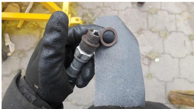
*Nota.* Esta figura representa el desmontaje de la bujía posterior del cilindro 6.
