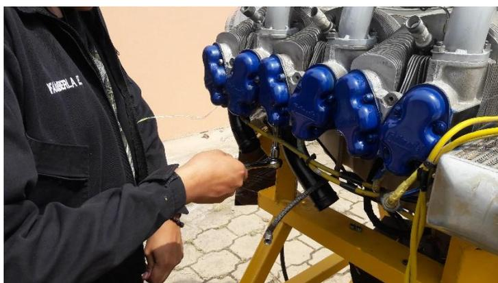
*Nota.* Esta figura representa la instalación del tubo de la cañería de escape del cilindro 6 del Motor Continental IO-360-D (21).
