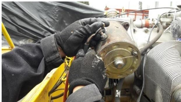
*Nota.* Esta figura representa el ajuste de los cables del alternador del Motor Continental IO-360-D (21).
