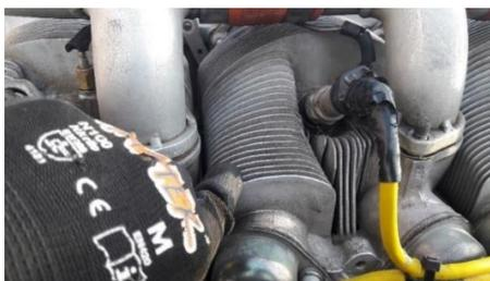
*Nota.* Esta figura representa una revisión de las aletas de refrigeración del cilindro del Motor Continental IO-360-D (21).
