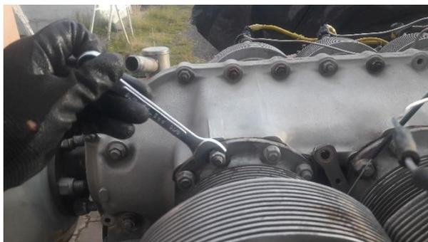
*Nota.* Esta figura representa retirada de los pernos de sujeción del cilindro 6 del Motor Continental IO-360-D (21).
