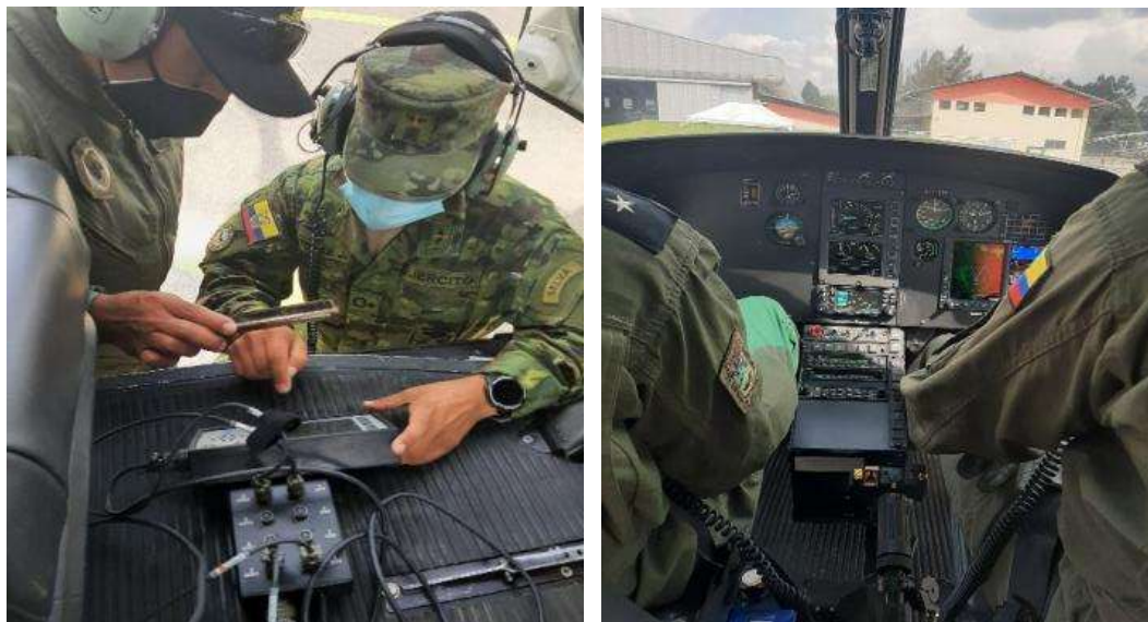
Figura 71 Corrección de vibraciones
