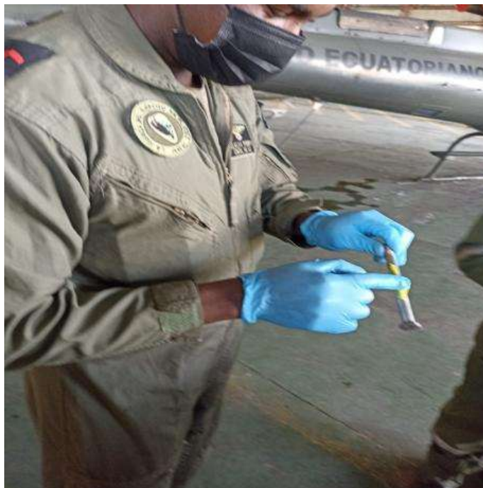
Figura 49 Aplicación de agente anticorrosivo
