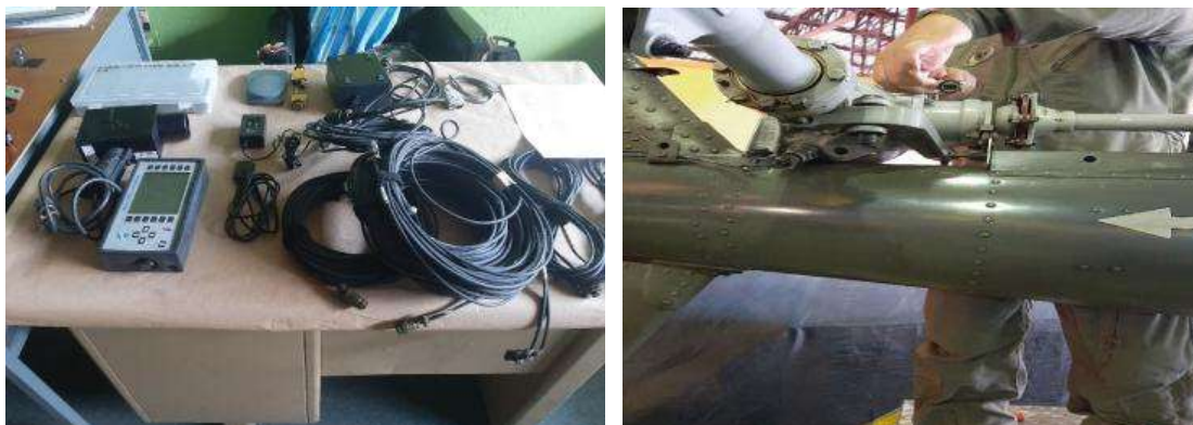
Figura 59 Instalación del equipo en el rotor de cola
