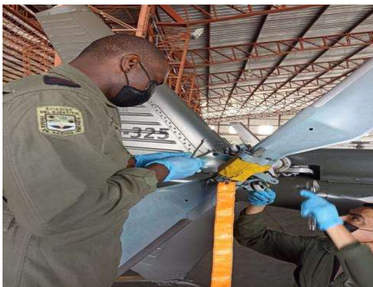
Desmontaje del rotor de cola
