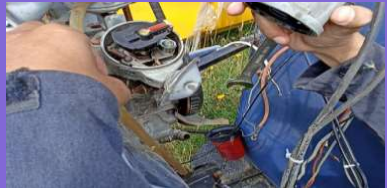
Inspección de contaminación en el distribuidor del motor
