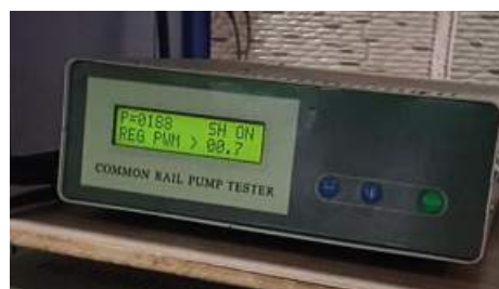
Figura 5. Control de apertura de inyección del inyector CRDI Bosch
