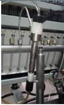
Figura 6. Comprobación de fuga externa del inyector Bosch 044 5110 310
