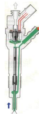
Figura 2. Funcionamiento de sistemas interno del inyector CRDI
