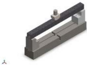
Figura 3. Esquema que de la probeta a ensayar con impactador y soporte.
