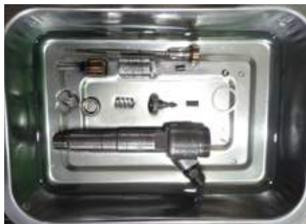
Figura 11. Limpieza del inyector Bosch
