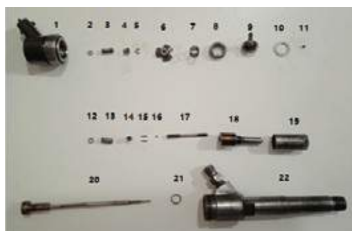
Figura 10. Despiece de las partes internas del inyector Bosch
