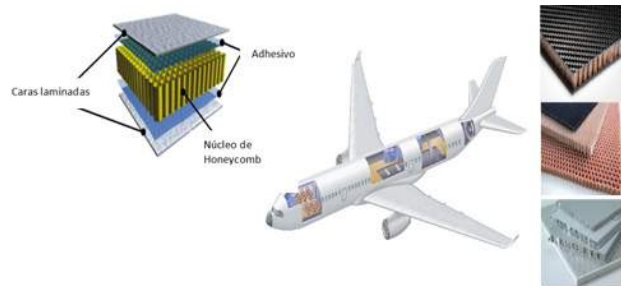
Figura 12. Estructura compuesta tipo sándwich (honeycomb)
