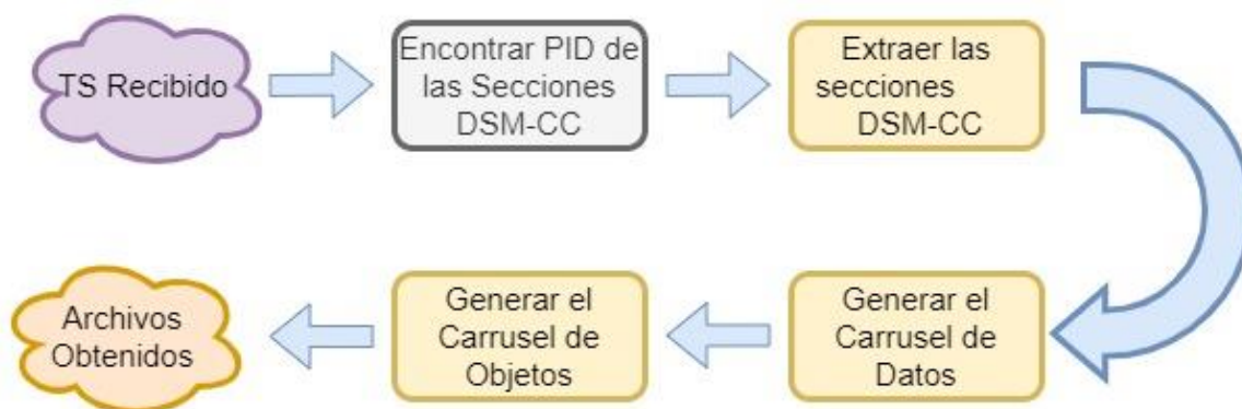
Figura 35 Estructura del algoritmo extractor de archivos
