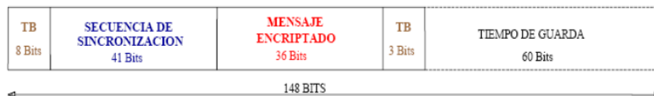
Figura. I.6. Estructura de una ráfaga de acceso
