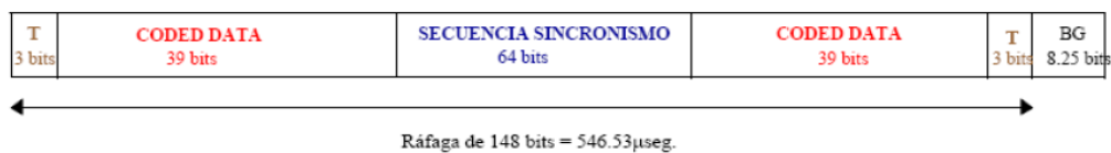
Figura. I.5. Estructura de una ráfaga de sincronización
