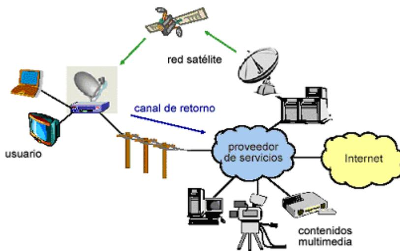
Figura 2. 5. Esquema Redes Satelitales Híbridas<sup>4</sup>
