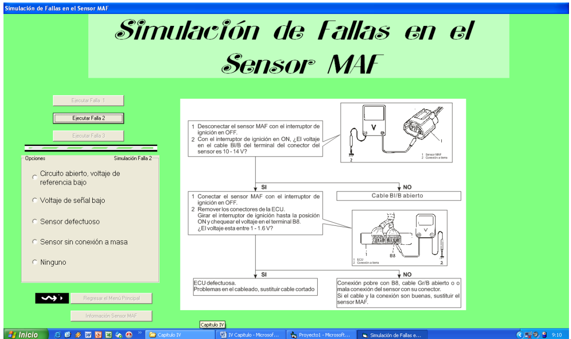
Fig. 4.45 Simulación de fallas en el sensor MAF
