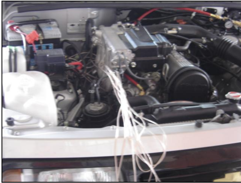
Fig. 4.29 Instalación del cableado en el motor del vehículo
