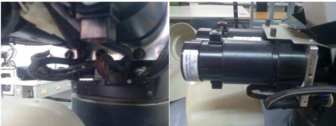
Figura. 3.11.1.- Servomotores y cableado del sistema robótico
