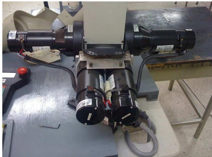
Figura.3.11.2.1.1 Estructura interna del brazo robótico CRS A255
